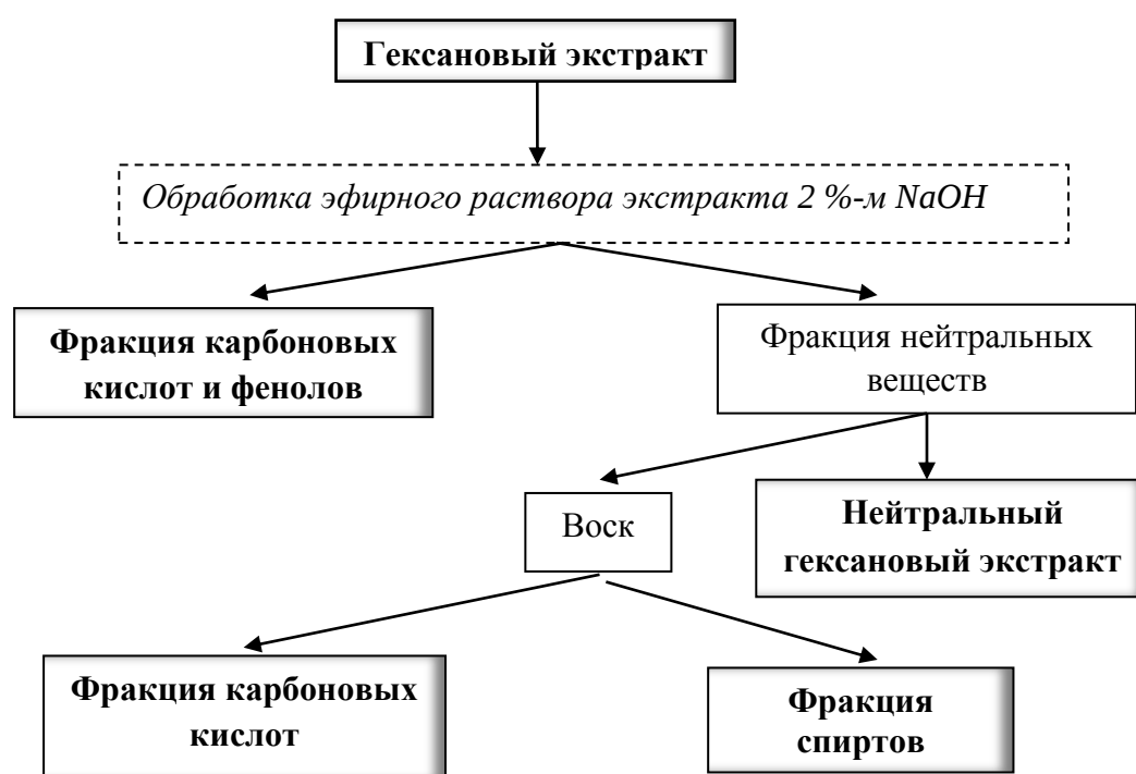
Рисунок 2.5 – Схема фракционирования гексанового экстракта мягкого этанолиза
