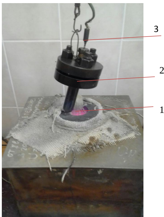
1 – керамическая печь, 2 – автоклав, 3 – термопара
