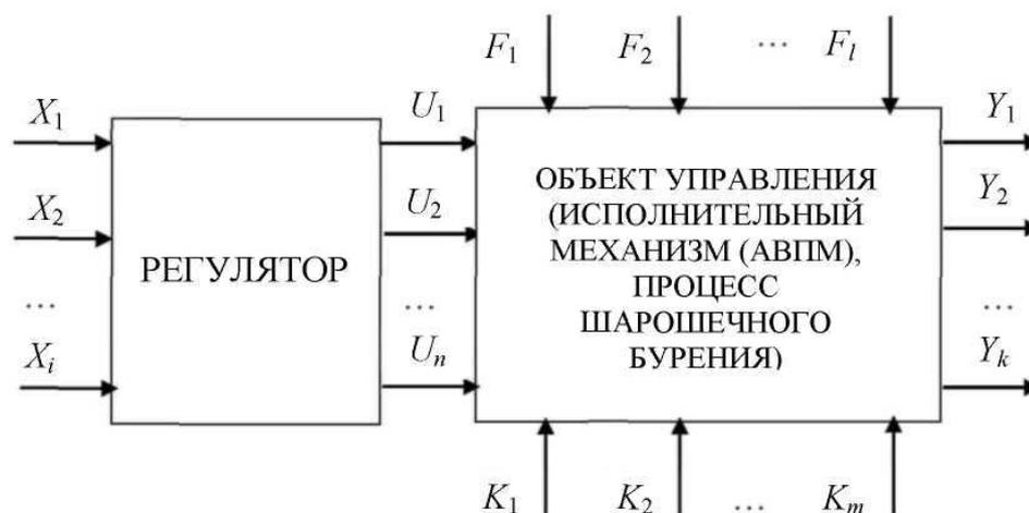
Рисунок 2.1 - Входные и выходные параметры объекта управления
