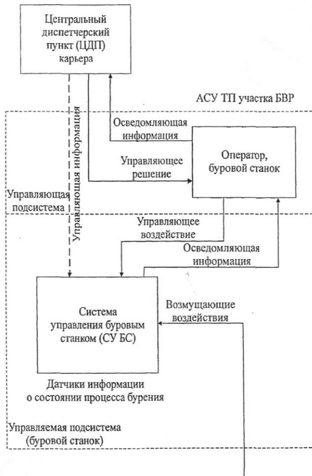
Рисунок 1.8 – Система управления буровым станком в структуре АСУ ТП участка БВР
