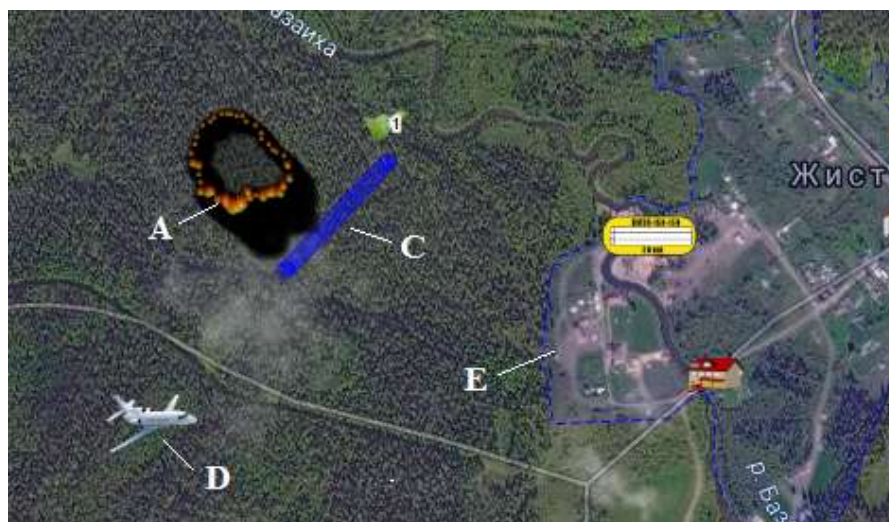
Рисунок 3.10 - Пример работы системы «Тайга-3»: A – кромка пожара (агенты типа- A ), C – полоса с повышенным уровнем влажности (сброс воды с самолета), D – самолет (агент типа- D ), E – населенный пункт (объект защиты)
