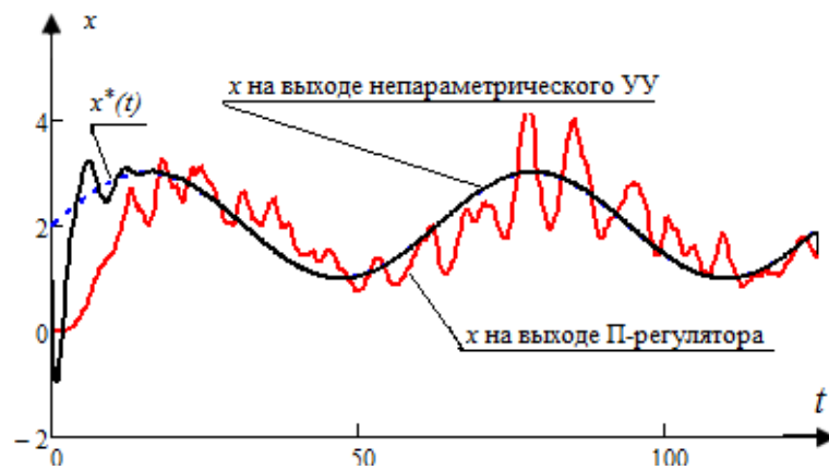
Рисунок 3.47 – Результат работы системы при задающем воздействии в виде траектории, исходная выборка без помех, W_{\Pi}=15\% , W_H=4.2\%
