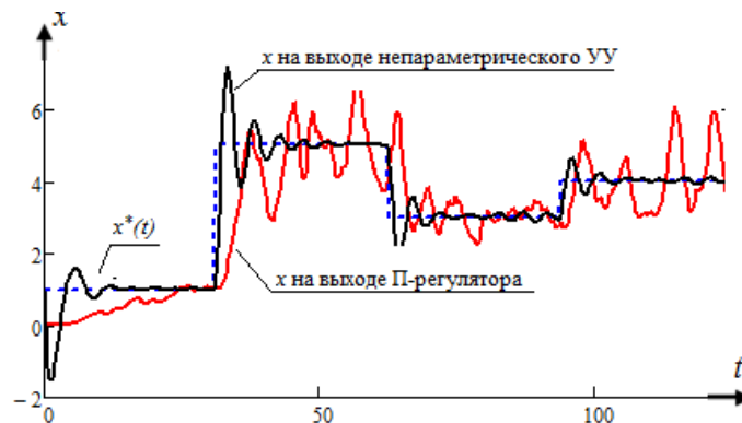
Рисунок 3.45 – Результат работы системы управления, на объект действует помеха 5% от значения его выхода, W_{\Pi}=32\% , W_H=2.7\%
