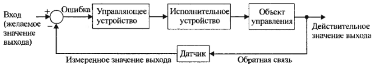
Рисунок 3.1 – Система с отрицательной обратной связью (регулятор)
