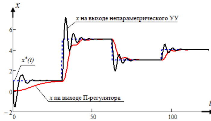
Рисунок 3.44 – Результат работы системы управления, W_{\Pi}=10\% , W_H=2.6\%
