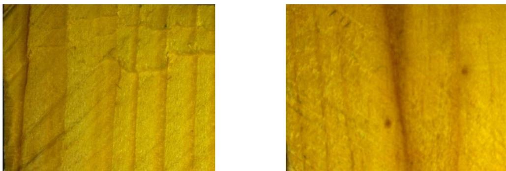
Рис. 5. 9 Наклон волокон при формировании закомелистости
