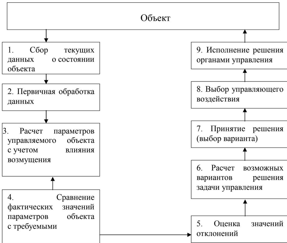
Рисунок 1.1 – Структура автоматизированной системы управления
