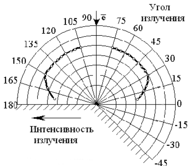
Рисунок 3.2 – Диаграмма пространственного распределения интенсивности рентгеновского излучения при угле падения пучка 90^\circ
