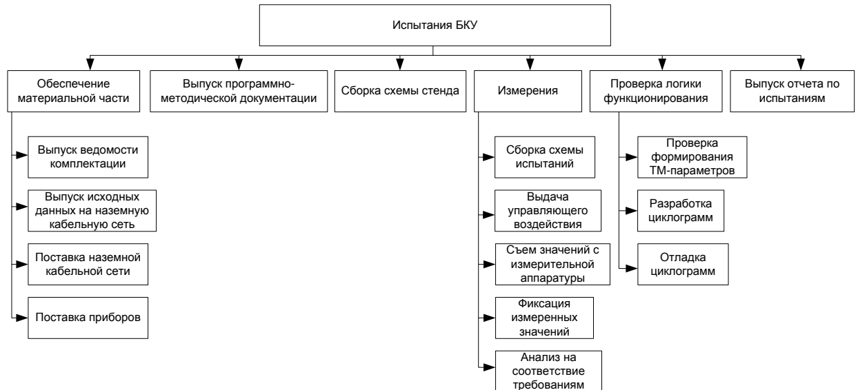
Рисунок 1.2 Схема технологического процесса проведения испытаний БКУ
