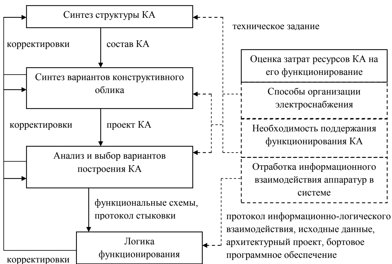
Рисунок 3.1 - Схема выполнения этапов внутреннего проектирования НКА
