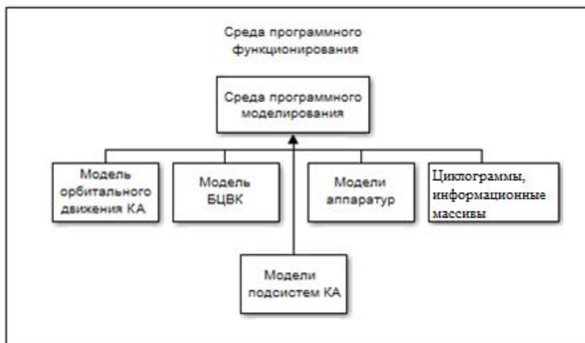
Рисунок 5.7 - Архитектура наземного отладочного комплекса
