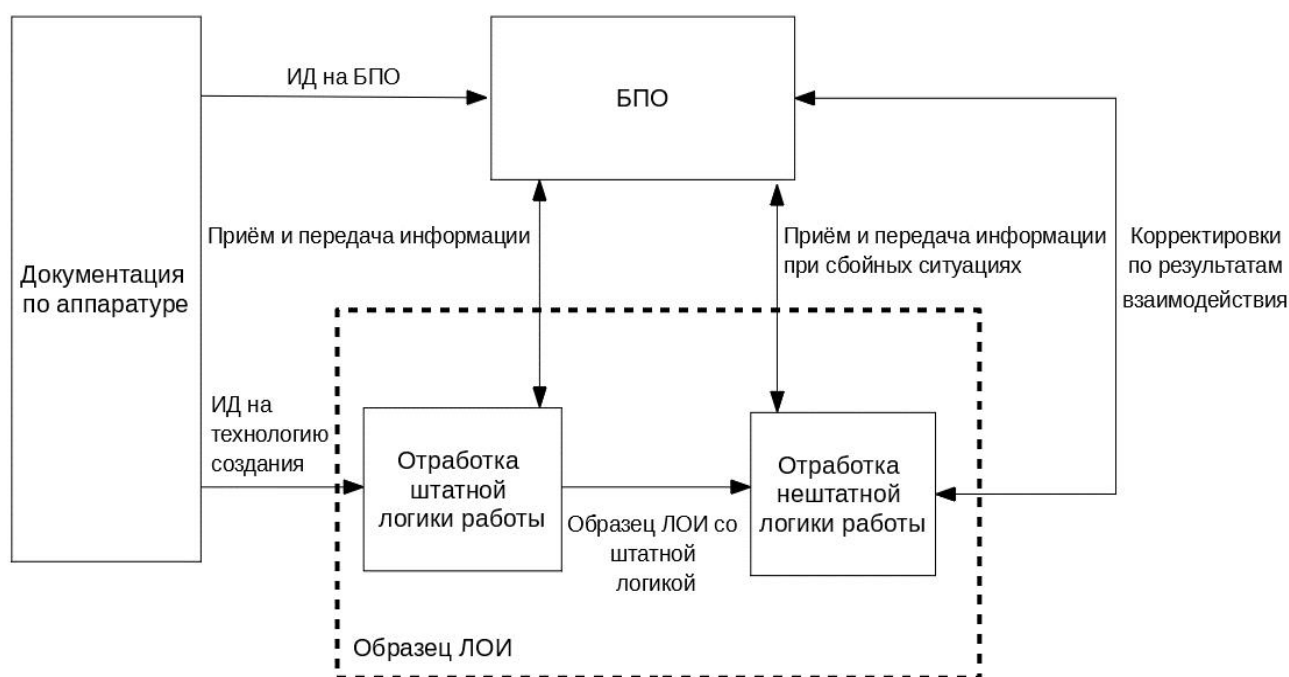
Рисунок 5.8 - Отработка взаимодействия бортового ПО с образцом ЛОИ
