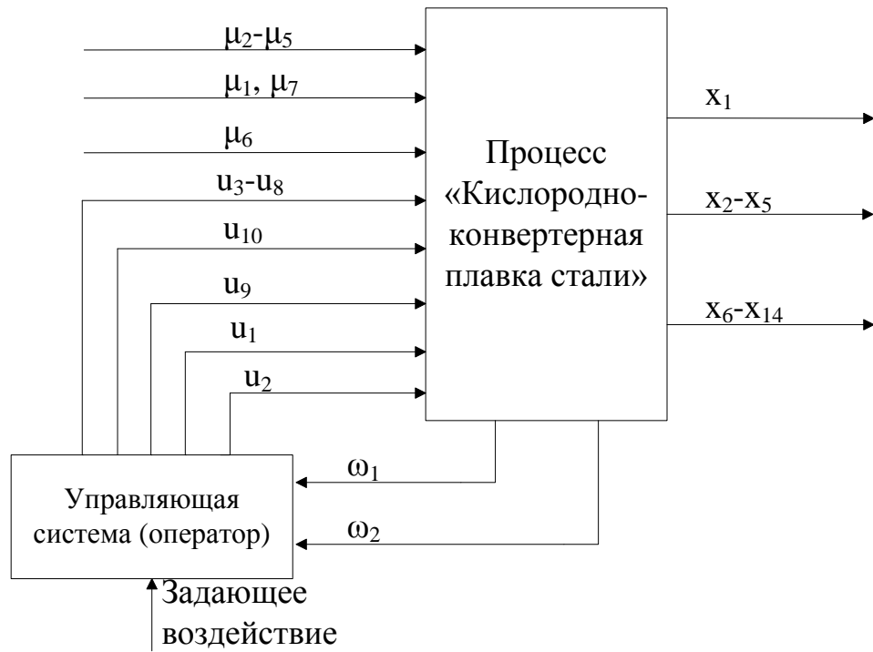
Рисунок 5.3 – Процесс кислородно-конвертерной плавки с точки зрения теории управления
