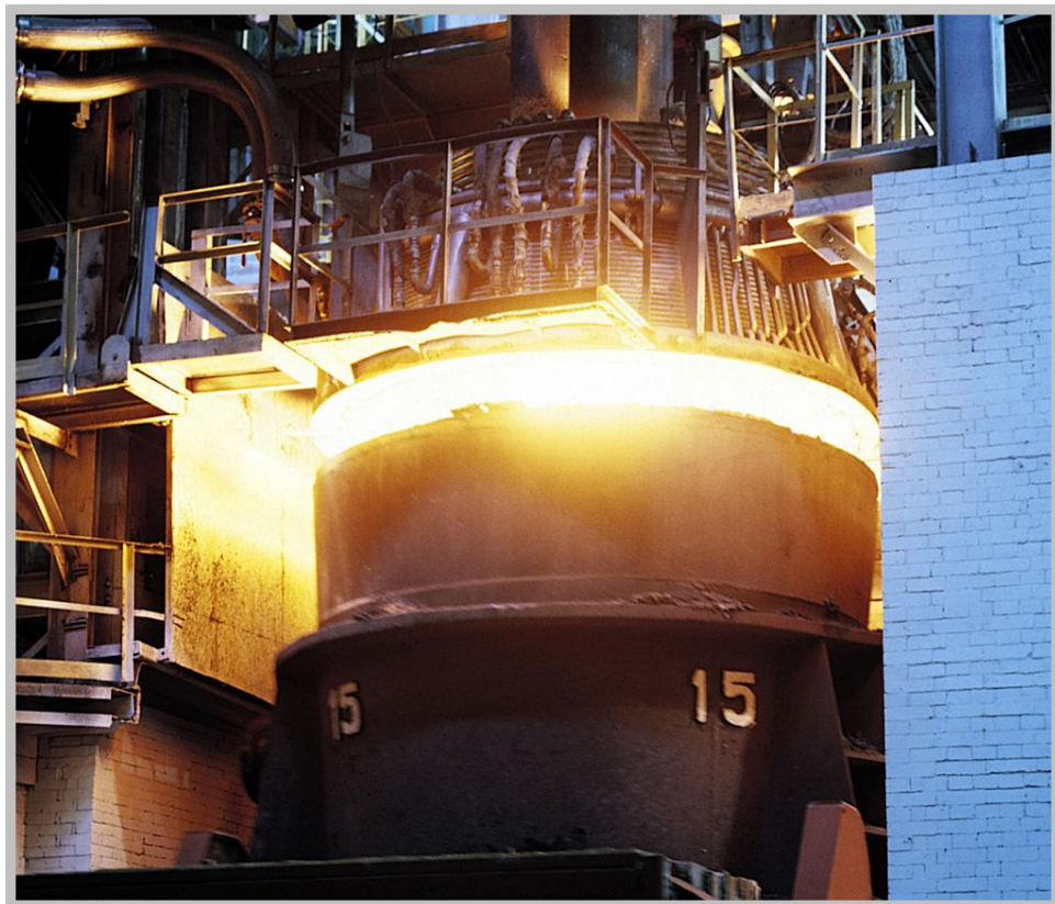
Рисунок 5.1 – Процесс кислородно-конвертерной плавки стали
