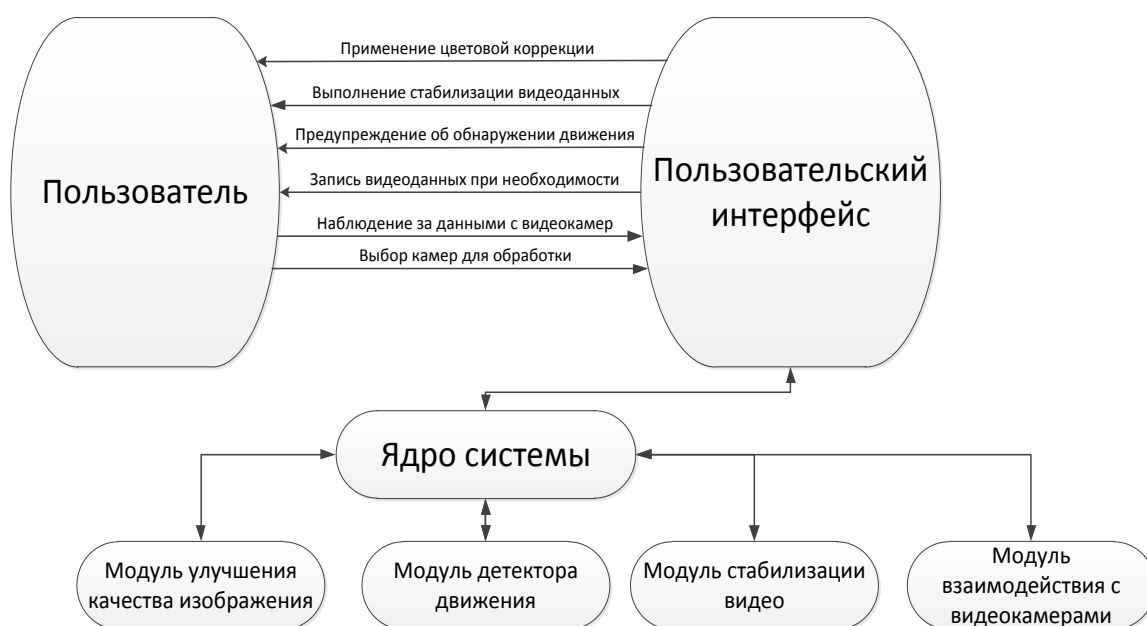
Рисунок 3.16 – Структура программного продукта «Система видеонаблюдения с возможностью улучшения визуального качества видеопотока»
