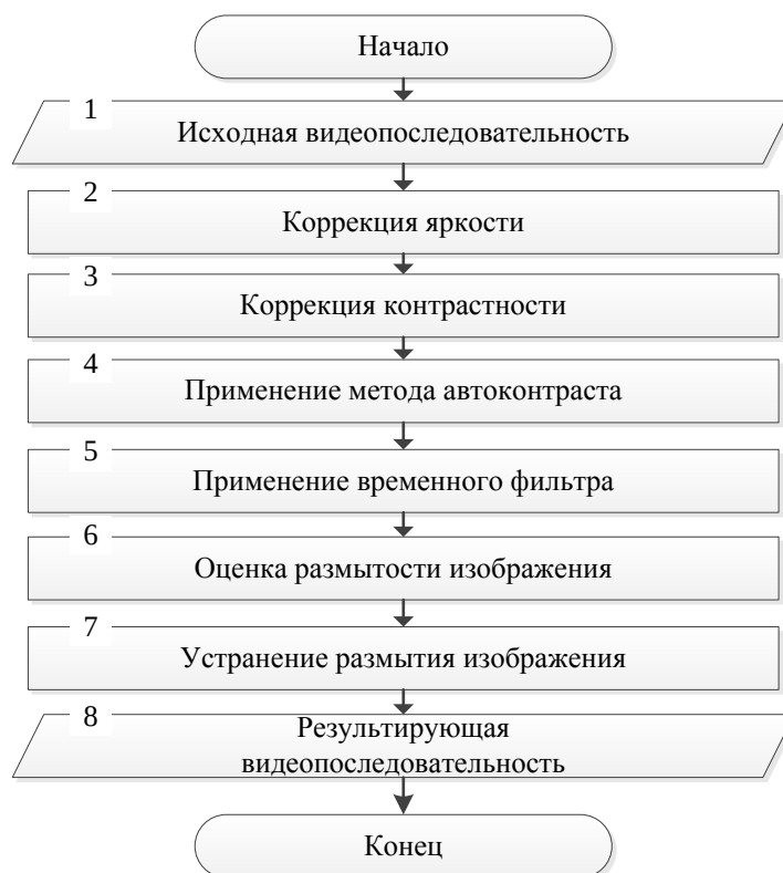
Рисунок 3.2 – Блок-схема работы модуля предварительной обработки видеопоследовательностей
