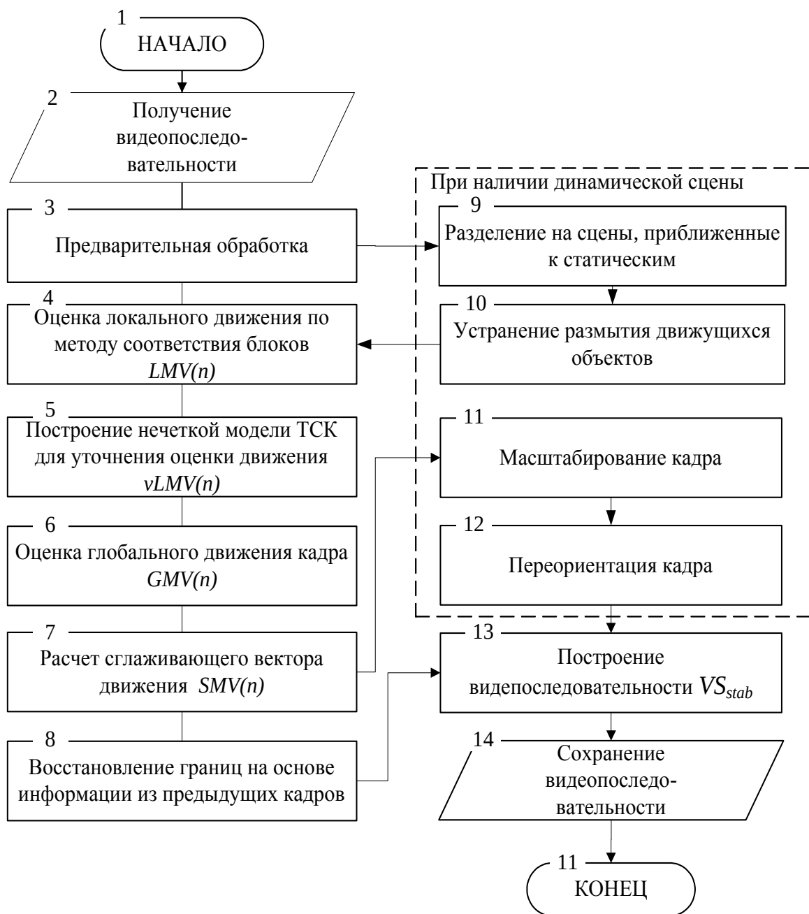
Рисунок 2.16 – Общая схема алгоритма стабилизации видеопоследовательностей
