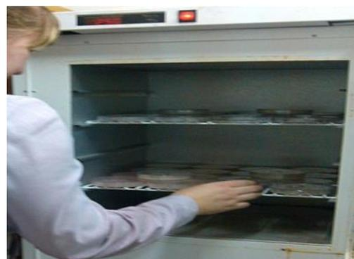
Рисунок 6 - Закладка семян на проращивание в термостат ТС-80 КЗМА
