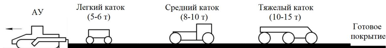
Рисунок 5. Технологическая схема уплотнения асфальтобетонной смеси
