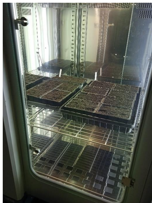
Рис. 5.12. Определение оптимального уровня искусственного освещения в климатических камерах
