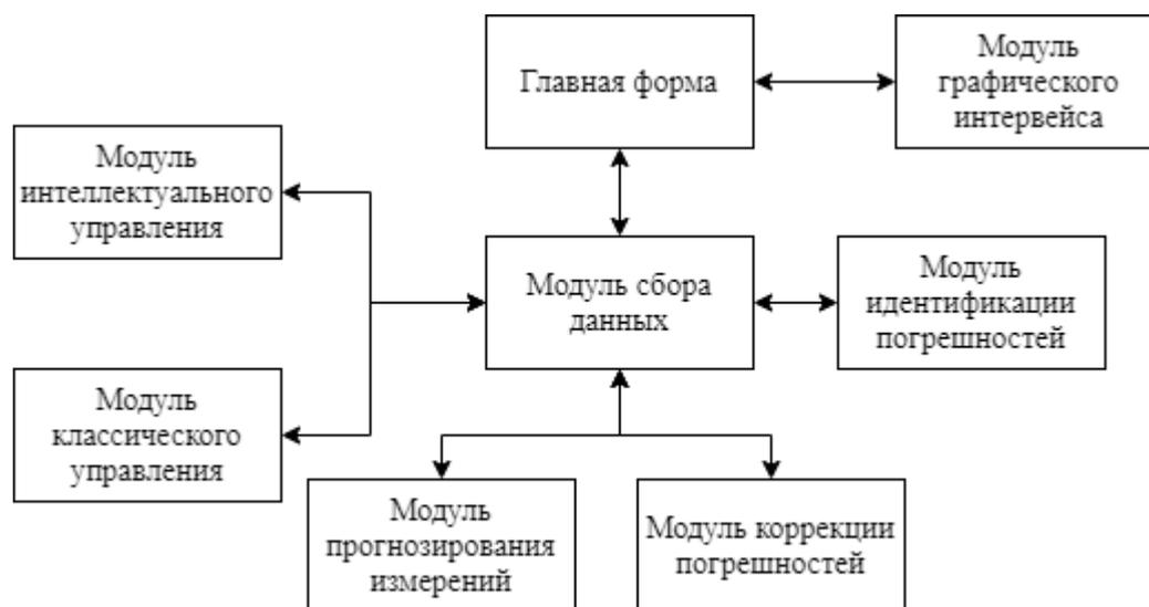
Рисунок 3.5 – Структурная схема программного продукта
