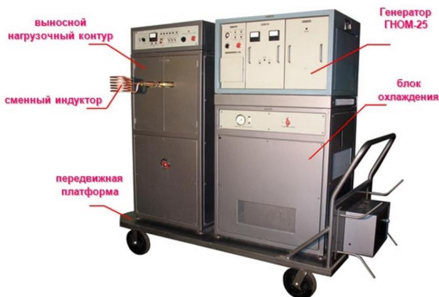
Рисунок 1.8 – Комплекс индукционных технологический КИТ-25
