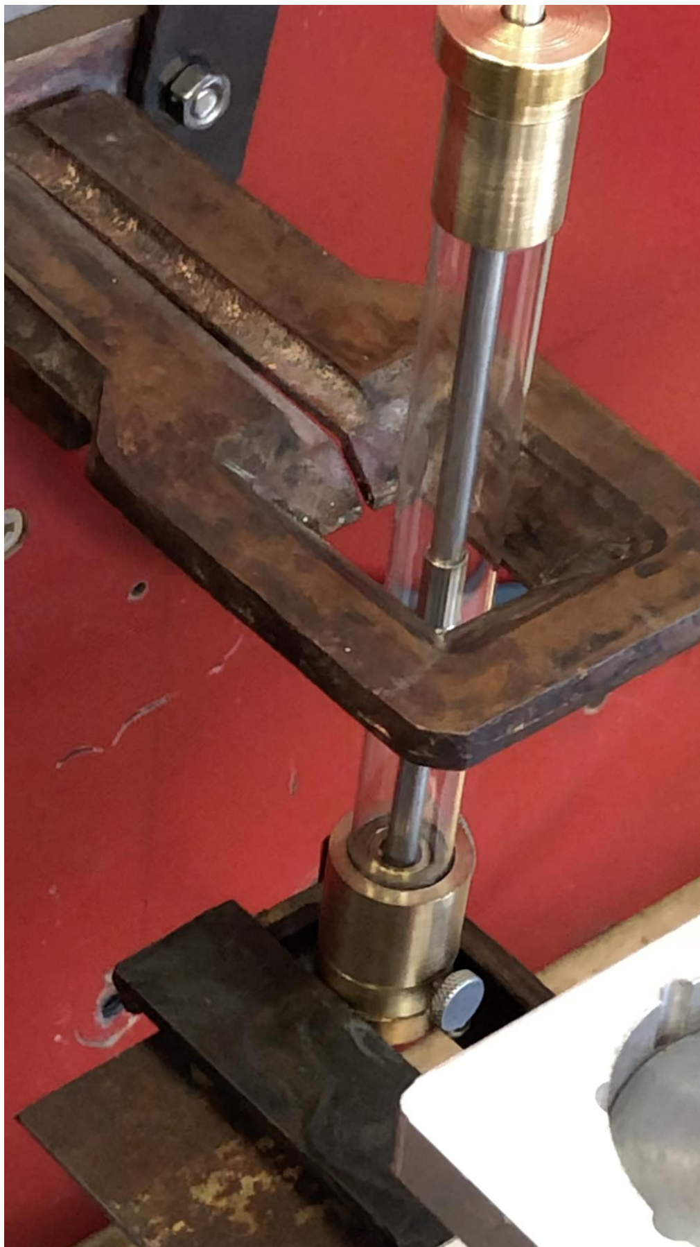
Рисунок 4.29 - Состояние изделия до начала индукционного нагрева
