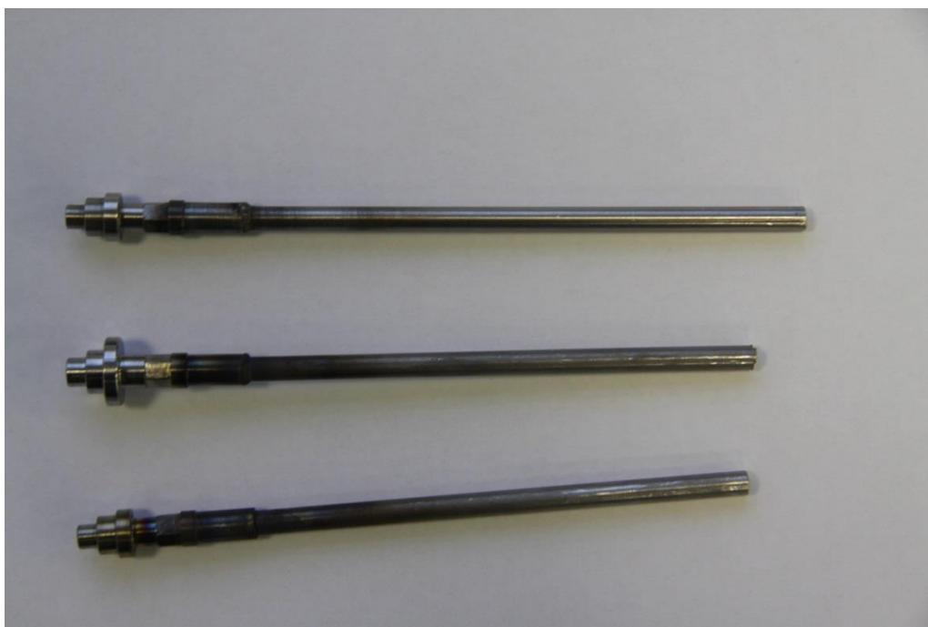
Рисунок 4.36 – Результаты индукционной пайки наконечников
