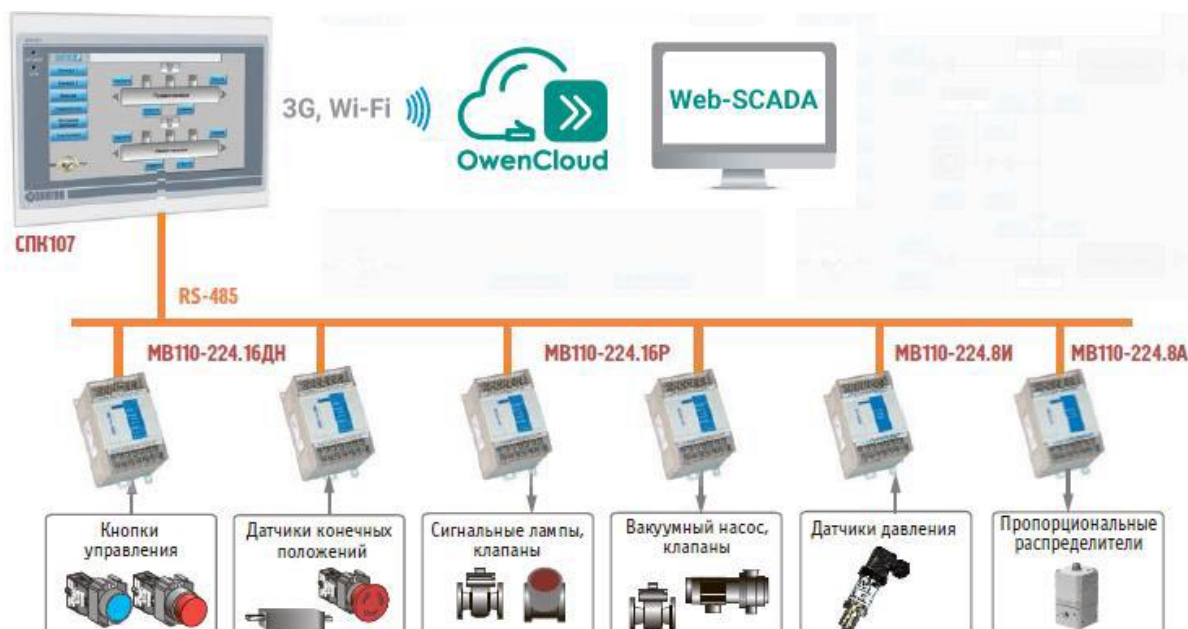
Рисунок 1.5 - Структурная схема автоматизированной системы управления пайкой
