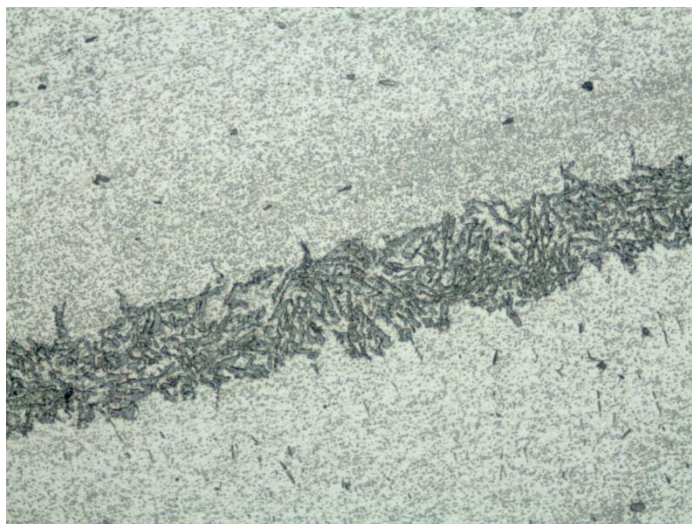
Рисунок 14 – Фрагмент паяного шва волновода сечением 35х15 мм, х500
