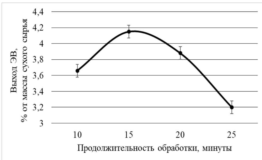
Рисунок 5 - Влияние продолжительности обработки ДЗ лиственницы на выход экстрактивных веществ в роторно-пульсационном аппарате
