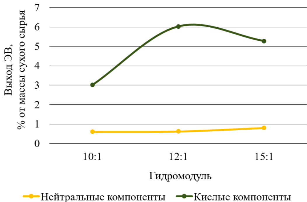
Рисунок 3 – Влияние ГМ эмульсионной экстракции ДЗ сосны на выход экстрактивных веществ в роторно-пульсационном аппарате
