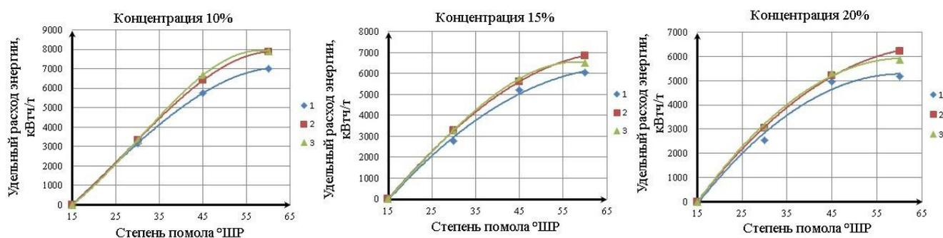
1 – гарнитура с окружной формой ножей, 2 – гарнитура секторная с прямолинейной формой ножей, 3 – гарнитура с прямолинейными ножами и равномерным их распределением
