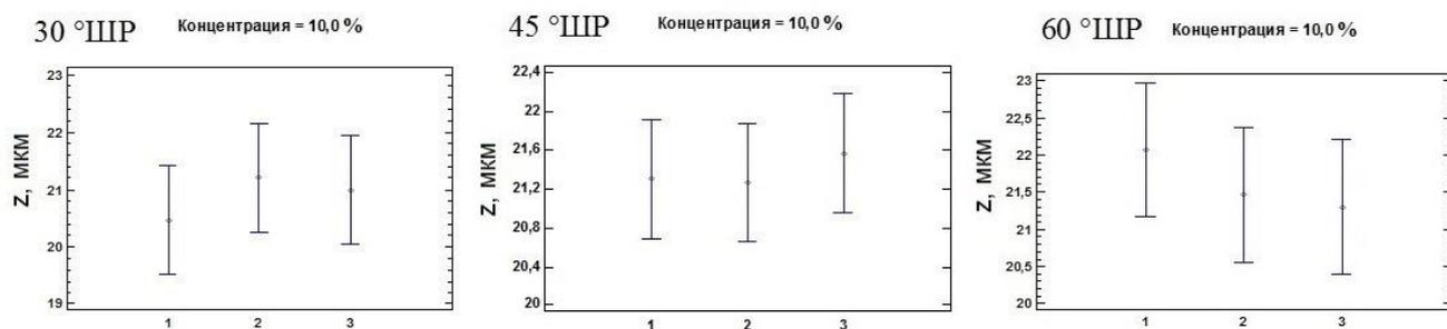
1 – гарнитура с окружной формой ножей, 2 – гарнитура секторная с прямолинейной формой ножей, 3 – гарнитура с прямолинейными ножами и равномерным их распределением
