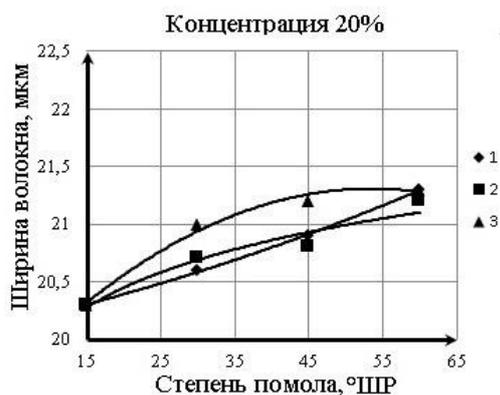
1 – гарнитура с окружной формой ножей, 2 – гарнитура секторная с прямолинейной формой ножей, 3 – гарнитура с прямолинейными ножами и равномерным их распределением
