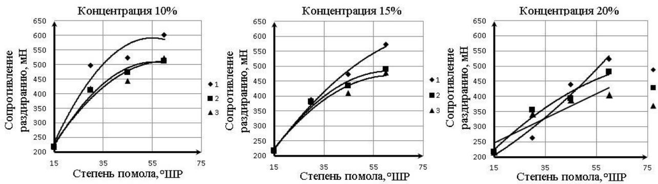
1 – гарнитура с окружной формой ножей, 2 – гарнитура секторная с прямолинейной формой ножей, 3 – гарнитура с прямолинейными ножами и равномерным их распределением
