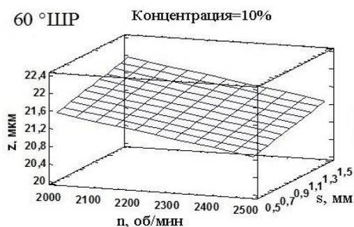
Рисунок 6 – Зависимость ширины волокна от частоты вращения ротора  $n$ , величины межножевого зазора  $s$  и концентрации волокнистой массы 10 % при степени помола 60 °ШР
