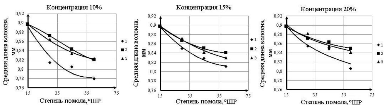
1 – гарнитура с окружной формой ножей, 2 – гарнитура секторная с прямолинейной формой ножей, 3 – гарнитура с прямолинейными ножами и равномерным их распределением
