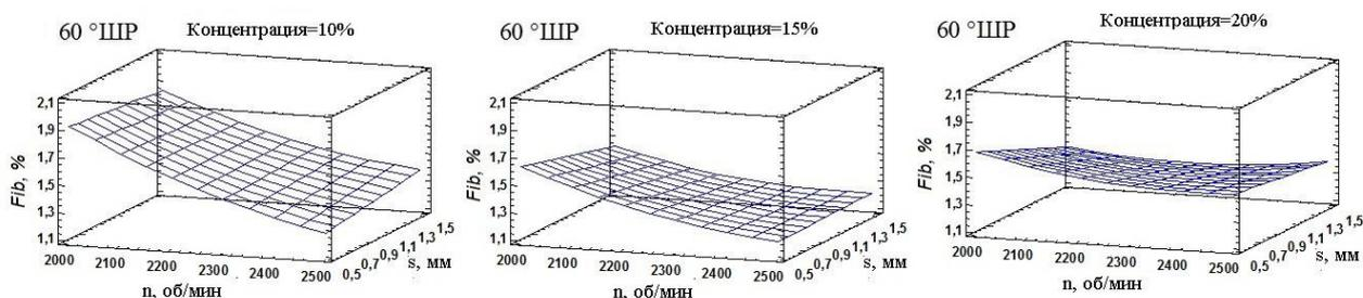
Рисунок 8 – Зависимость индекса фибрилляции от частоты вращения ротора  $n$ , величины межножевого зазора  $s$  и концентрации волокнистой массы  $C$  при степени помола  $60^\circ$ ШР
