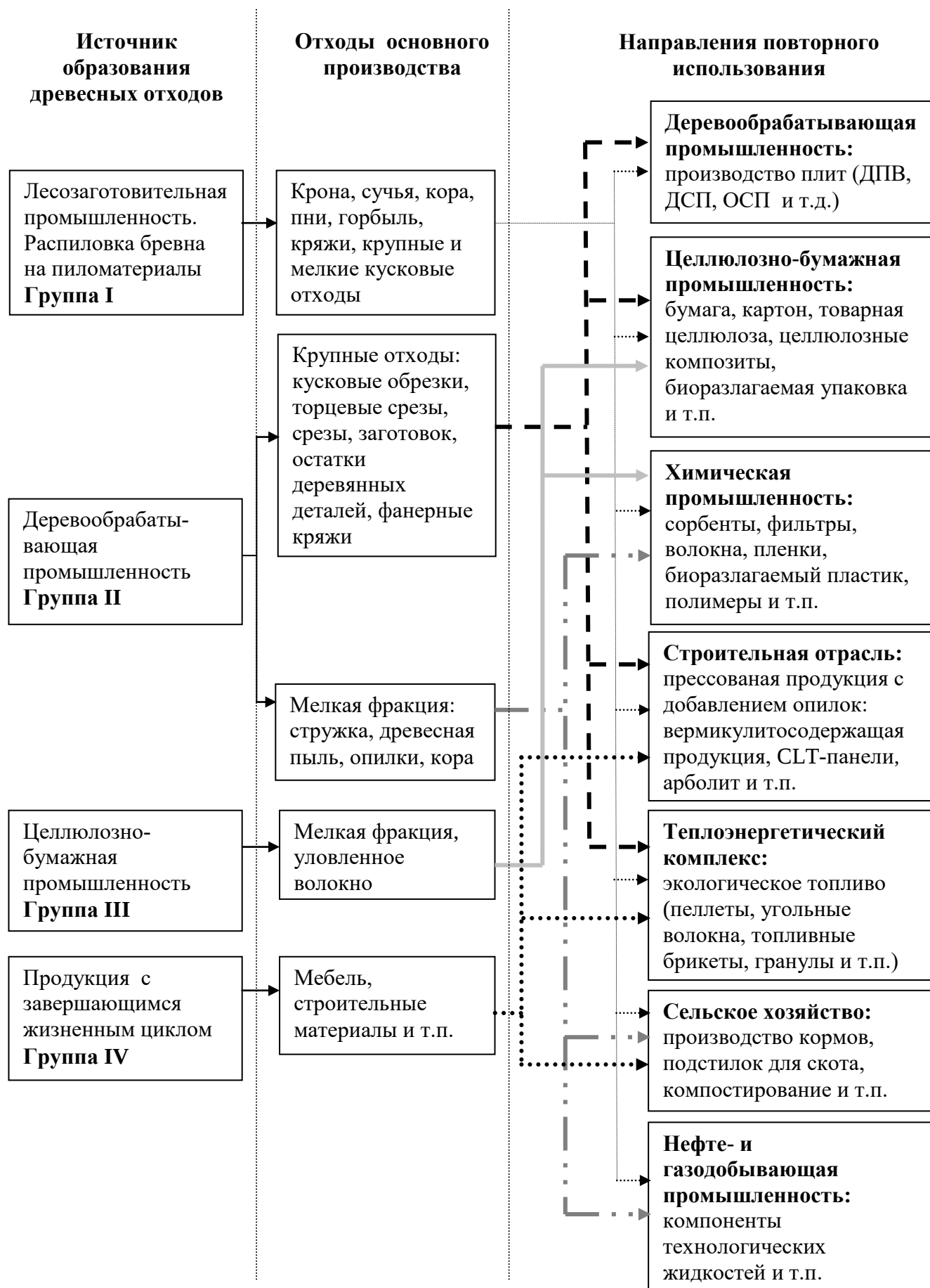
Рисунок 1 – Классификация древесных отходов и направления их использования
