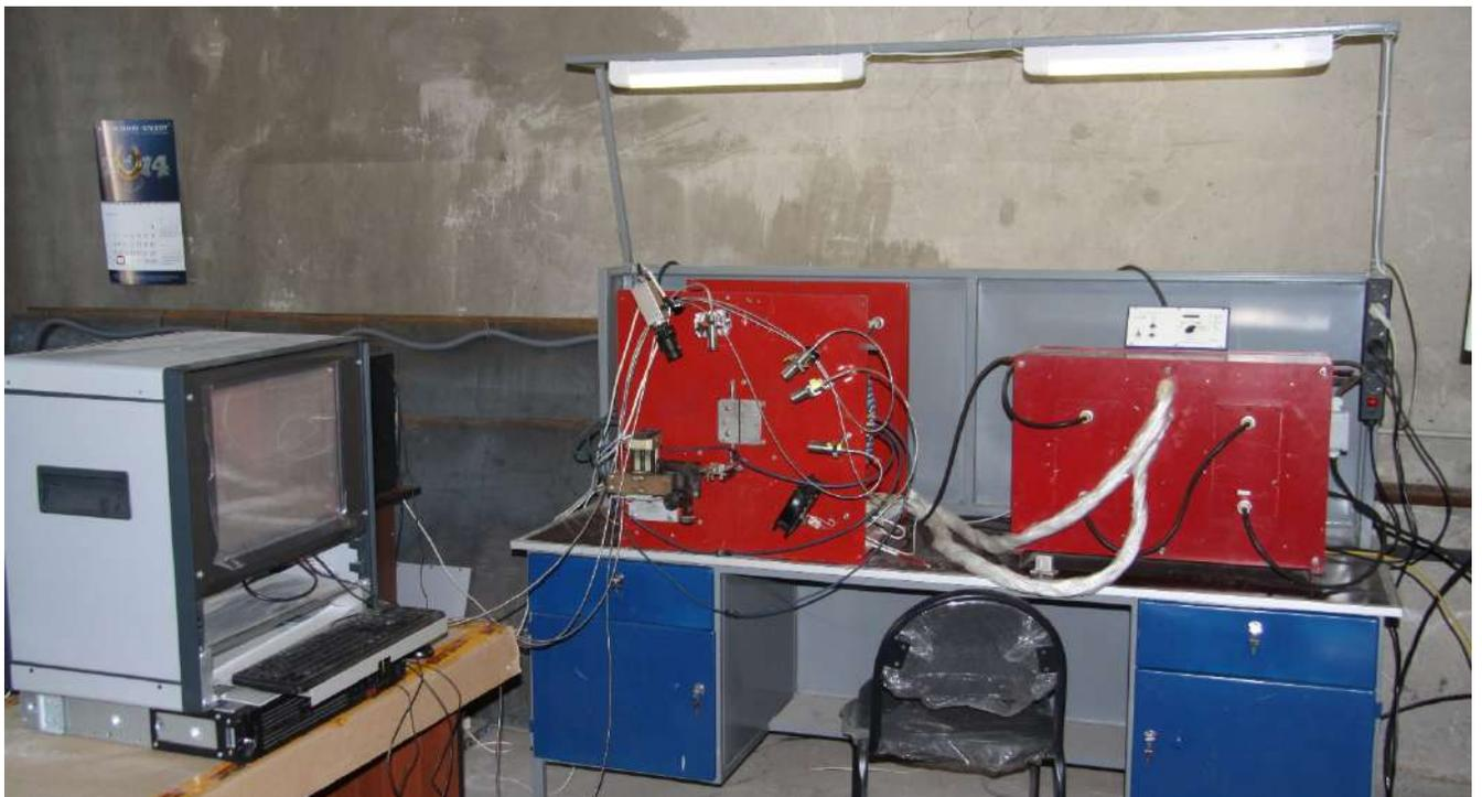
Рисунок 5.4 – Внешний вид комплекса автоматизированного оборудования для пайки волноводных трактов
