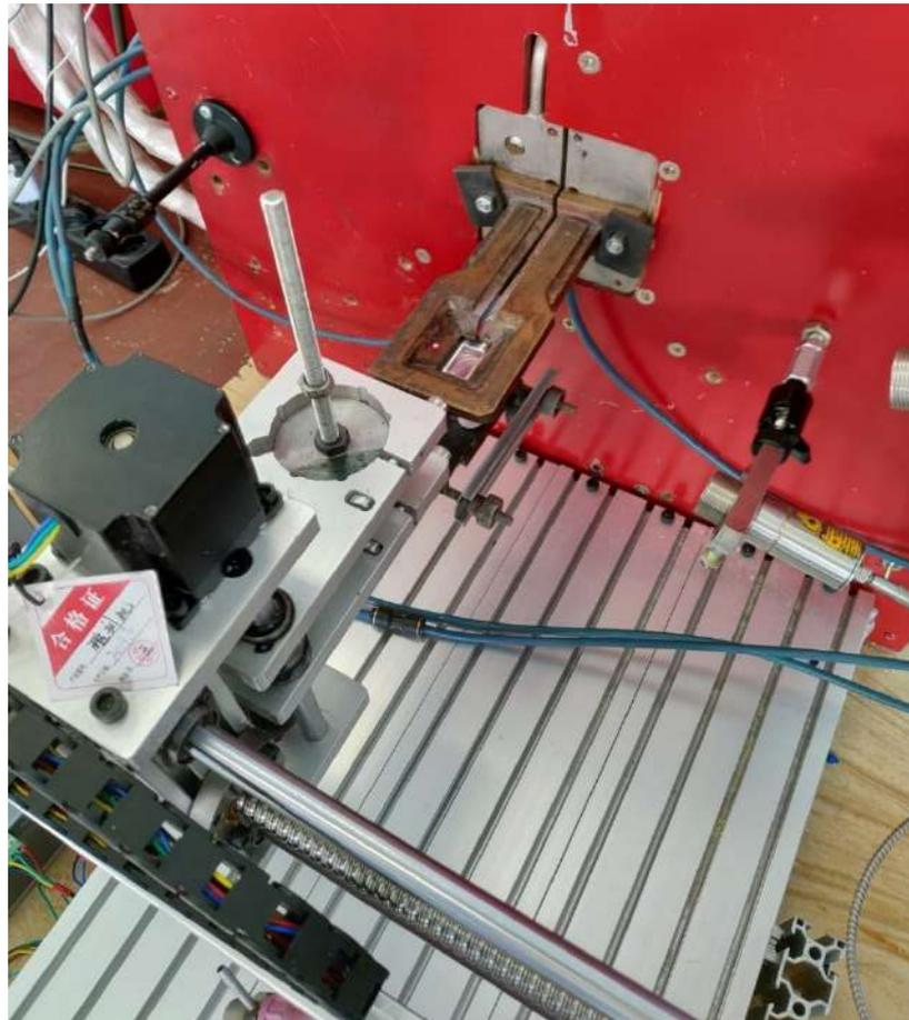
Рисунок 5.26 – Установка индукционной пайки – вид сверху
