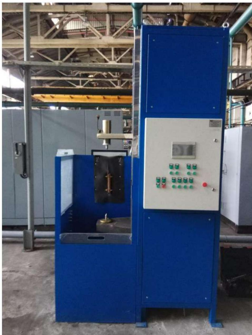
Рисунок 1.16 – Установка индукционного нагрева ФТИ 3.148.1
