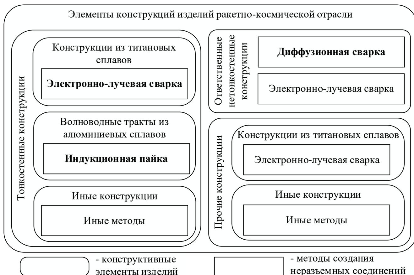
Рисунок 1.1 – Схема применения исследуемых процессов при создании неразъемных соединений элементов конструкций изделий РКО
