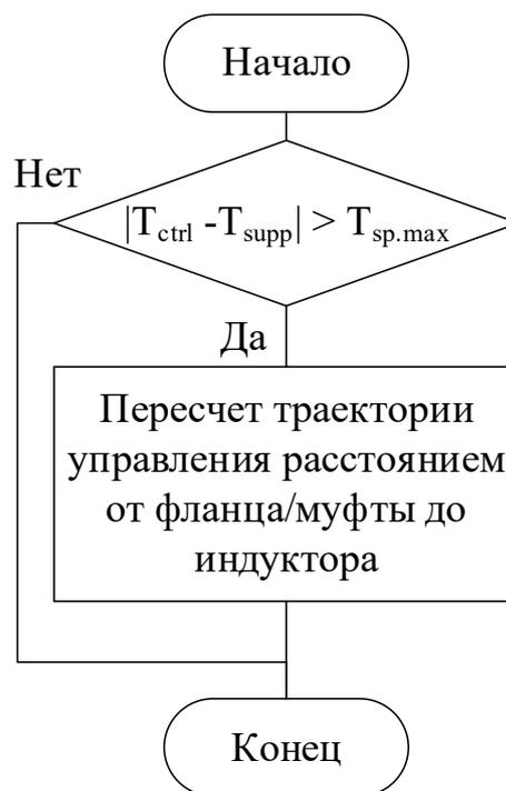
Рисунок 4.26 – Коррекция расстояния от фланца/муфты до индуктора в процессе оптимального управления на шаге  $i$ , где  $T_{sp.max}$  – заданное максимально возможное отклонение температуры фланца/муфты от волноводной трубы
