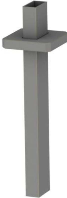
Рисунок 2.10 – Сборка волноводного тракта труба-фланец-труба
