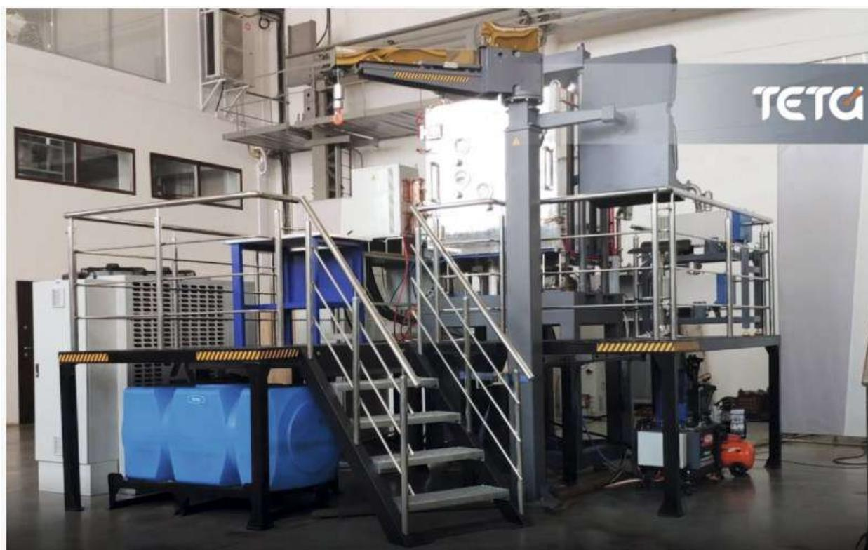
Рисунок 1.19 – Установка TETA DW100 для диффузионной сварки в вакууме
