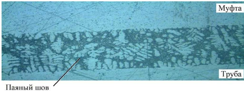
Рисунок 5.49 – Микрошлиф фрагмента паяного шва волноводной сборки труба-муфта типоразмера  $19 \times 9,5$  мм (масштаб 100:1)
