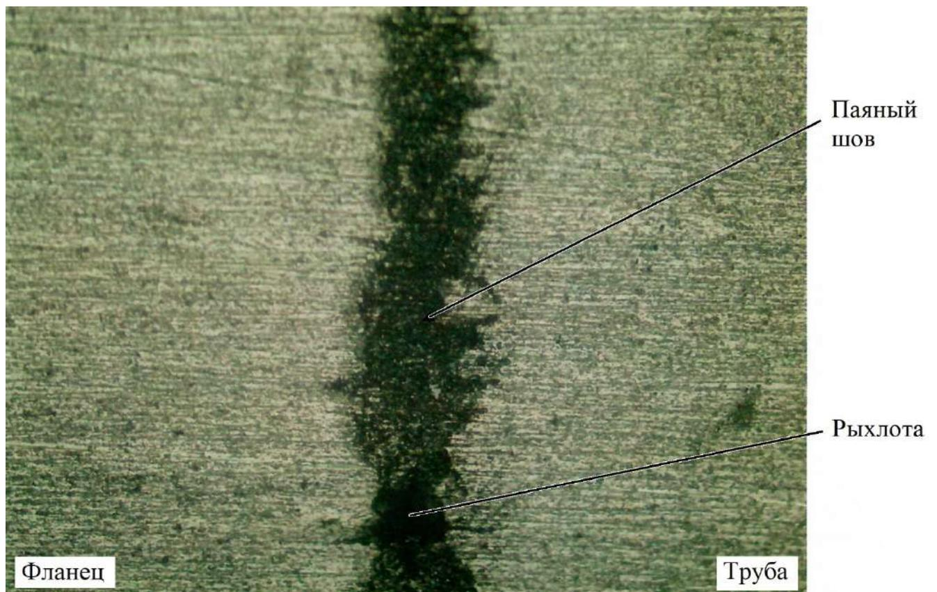
Рисунок 5.38 – Микрошлиф фрагмента паяного шва волновода, сборка труба-фланец (масштаб 200:1)
