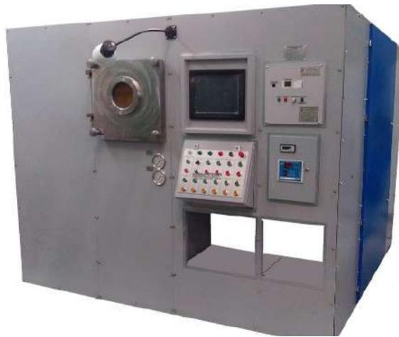
Рисунок 1.17 – Установка для диффузионной сварки УДВ-35.01
