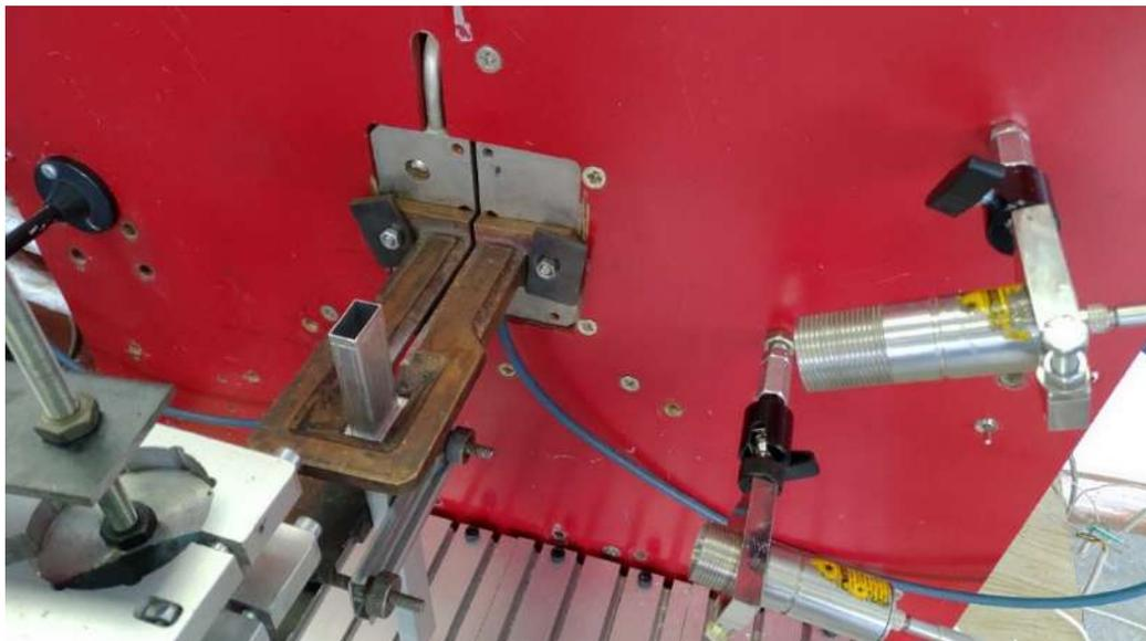
Рисунок 5.24 – Установка индукционной пайки – вид сверху
