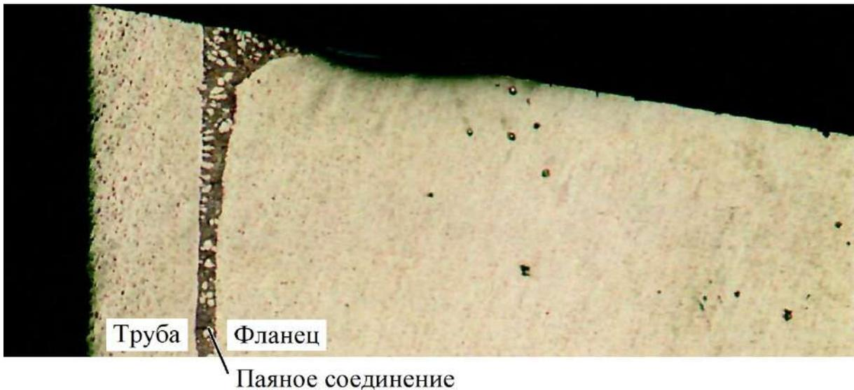
Рисунок 5.19 – Микршлиф фрагмента паяного шва волноводной сборки труба-фланец типоразмера 58×25 мм (масштаб 25:1)
