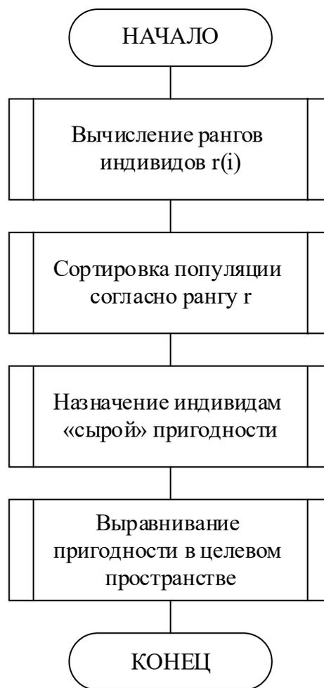
Рисунок 3.12 – Блок-схема назначения пригодностей в FFGA
