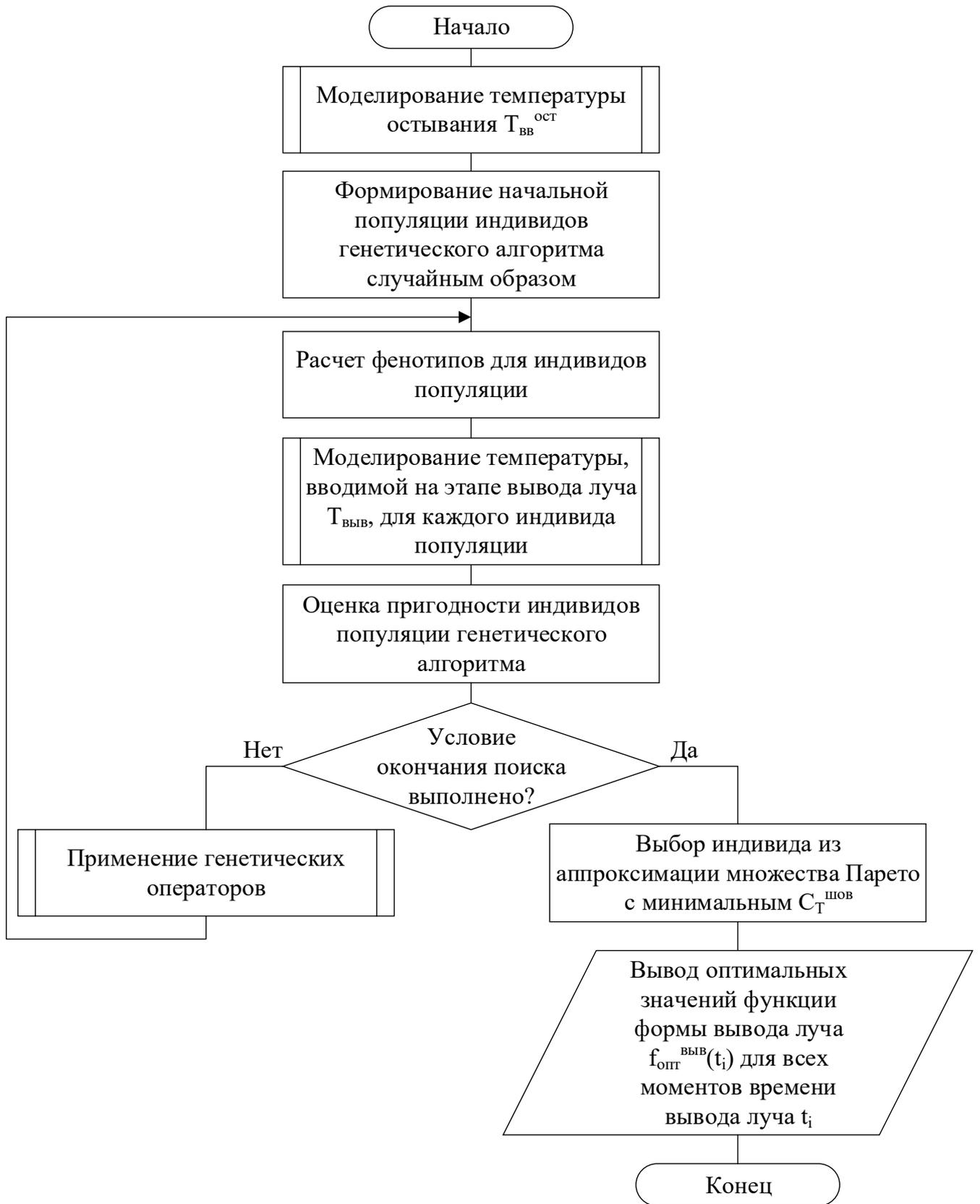
Рисунок 4.31 – Эволюционный алгоритм построения траектории оптимального управления выводом луча
