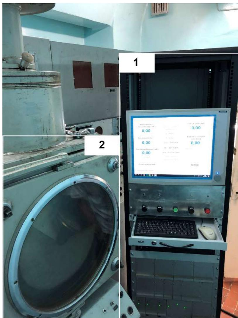
Рисунок 5.51 – Общий вид установки ЭЛС, где 1 – система автоматизированного управления ЭЛС; 2 – вакуумная камера для размещения свариваемых изделий
