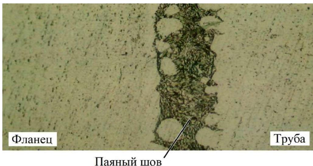
Рисунок 5.50 – Микрошлиф фрагмента паяного шва волноводной сборки труба-фланец типоразмера  $21 \times 11$  мм (масштаб 200:1)
