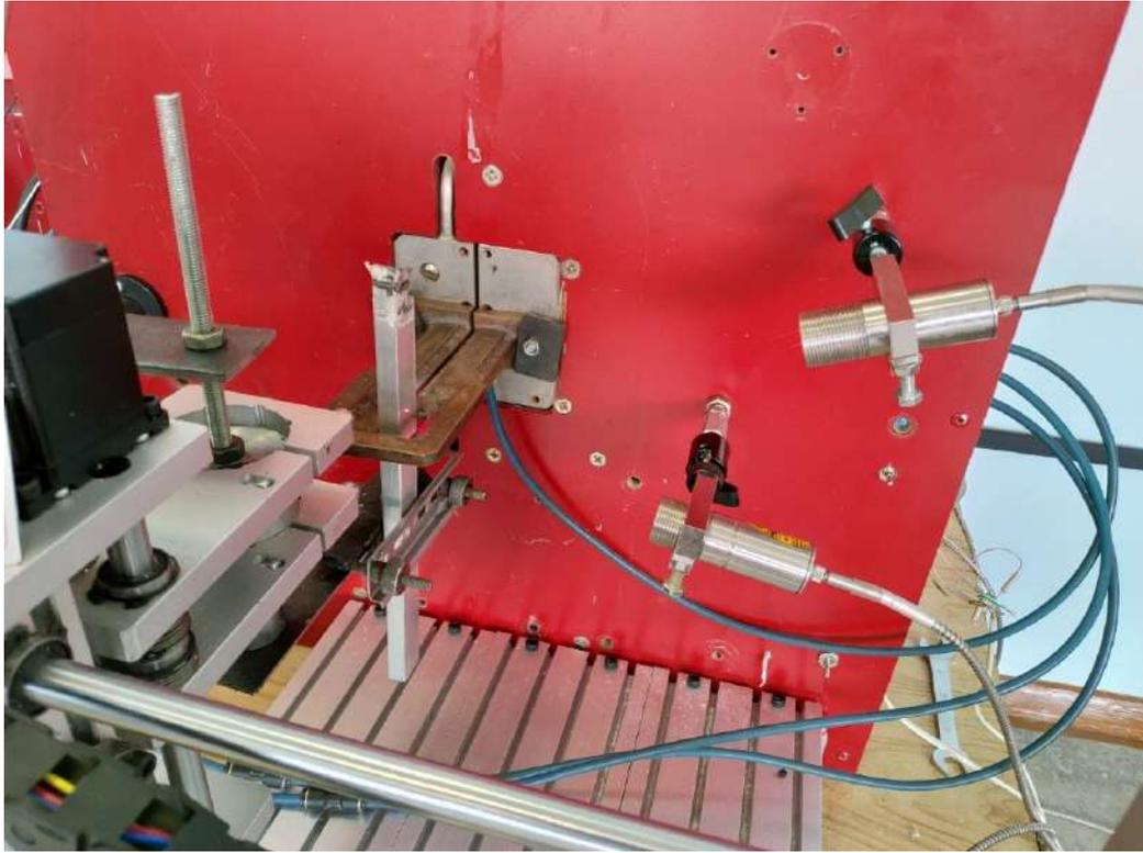
Рисунок 5.25 – Установка индукционной пайки – вид спереди
