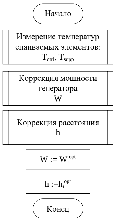
Рисунок 22 – Управление на основе оптимальной траектории на шаге i
