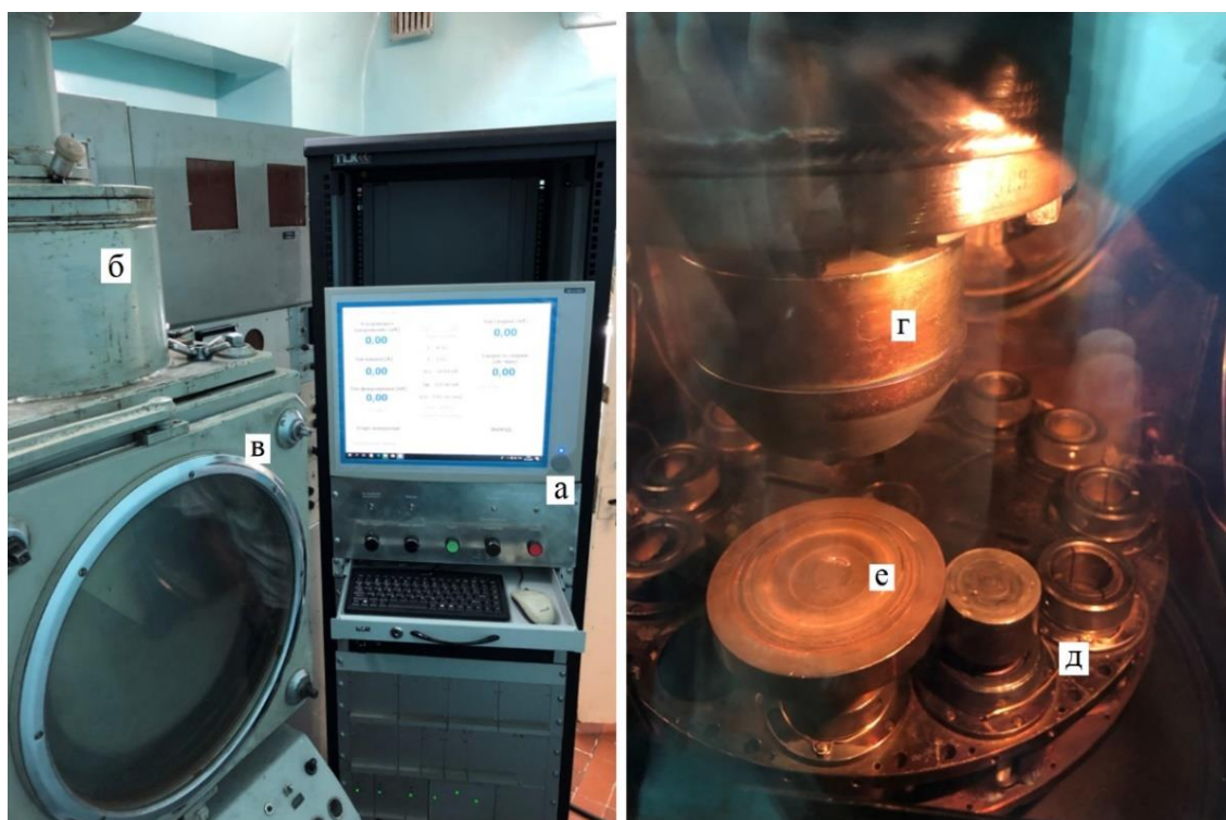
Рисунок 3 – Автоматизированное оборудование ЭЛС: а – автоматизированное оборудование установки ЭЛС; б – корпус электронно-лучевого оборудования; в – вакуумная камера; г – электронно-лучевая пушка; д – поворотный сварочный стол; е – имитатор изделия
