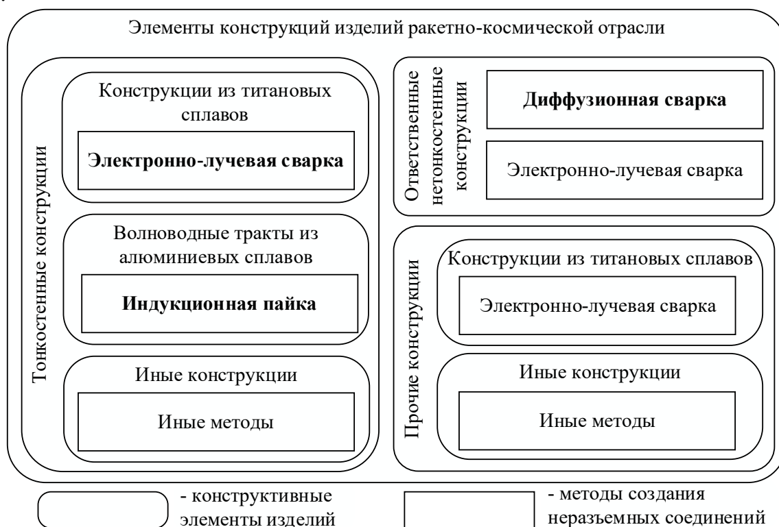
Рисунок 1 – Схема применения исследуемых процессов при создании неразъемных соединений элементов конструкций изделий РКО
