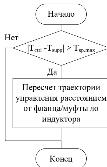
Рисунок 24 – Коррекция расстояния от фланца/муфты до индуктора в процессе оптимального управления на шаге i , где T_{sp.max} – заданное максимально возможное отклонение температуры фланца/муфты от волноводной трубы
