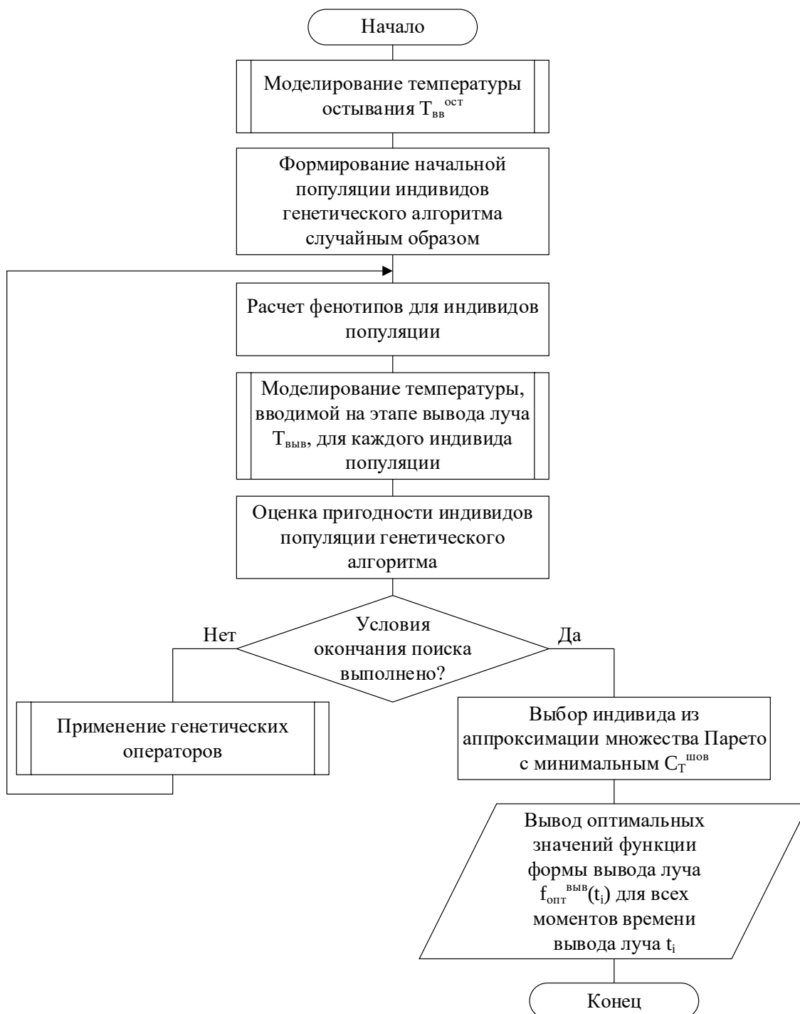
Рисунок 26 – Эволюционный алгоритм построения траектории оптимального управления выводом луча
