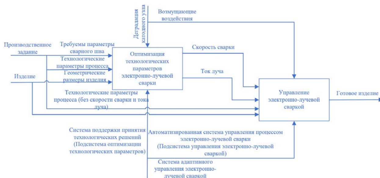
Рисунок 2.33 – Процессная модель адаптивного управления ЭЛС. Диаграмма декомпозиции по методологии IDEF0
