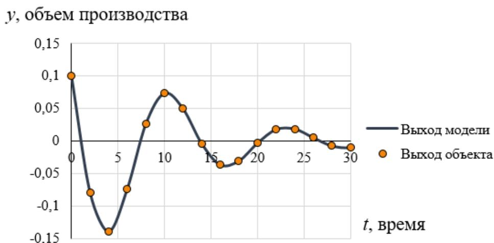
Рисунок 3.65 – Соответствие исходной выборки выходу полученной модели (задача 3, объем выборки 16, шум 0)
