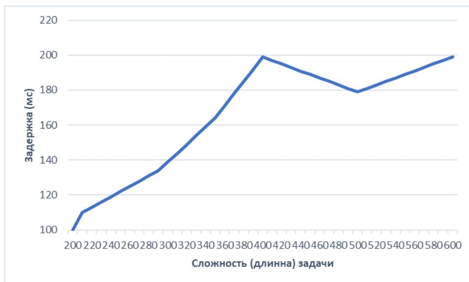
Рисунок 6 – Задержка задачи с использованием предложенного подхода
