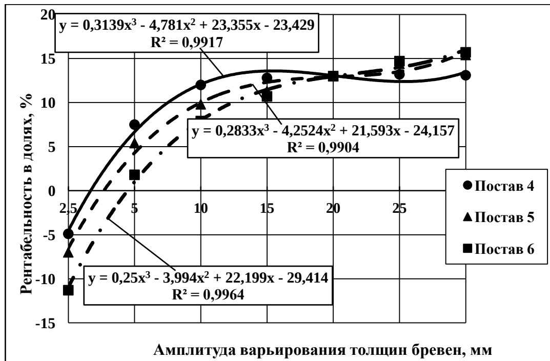
Рисунок 4.12 – Зависимость рентабельности лесопильного производства от амплитуды варьирования толщины брёвен в распиловочной партии 22 см/4 м при доле сырьевых затрат ДСЗ = 0,8 и при длинах досок от 1,5 до 6,3 с градацией 0,3 м
