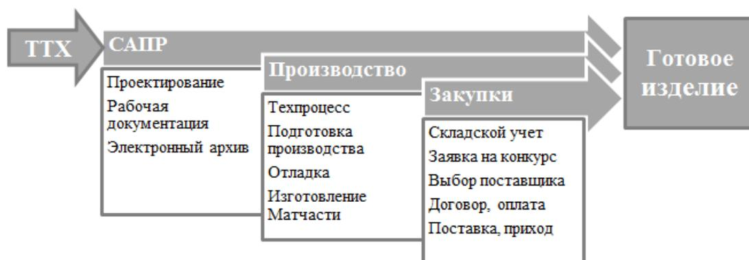
Рисунок 2.6 – Основные инструменты управления ЖЦ создания продукции
