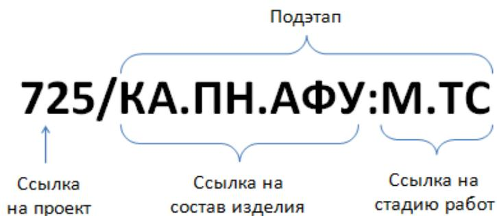
Рисунок 3.9 – Пример кода работы в системе управления проектами на предприятии РКО
