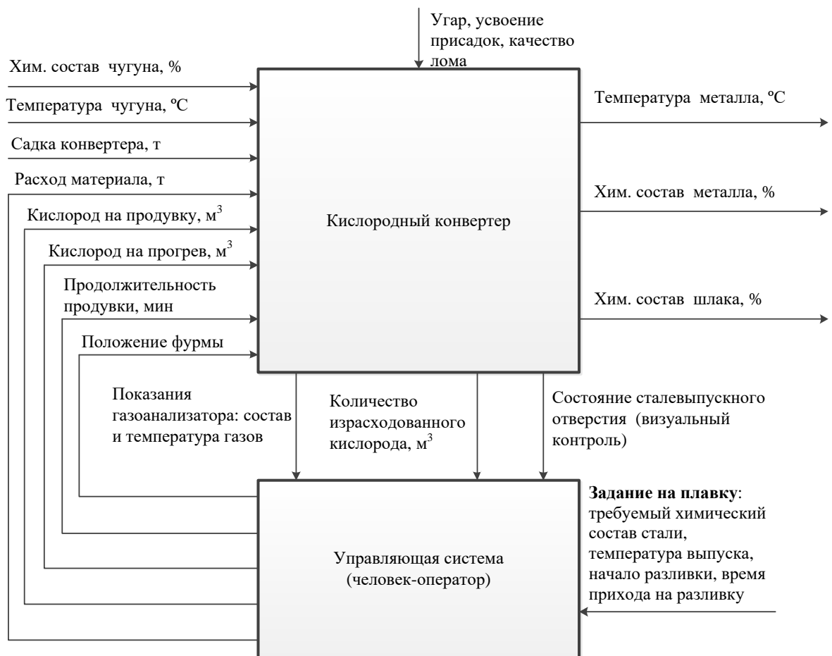
Рисунок 5.2 – Схема процесса кислородно-конвертерной плавки стали
