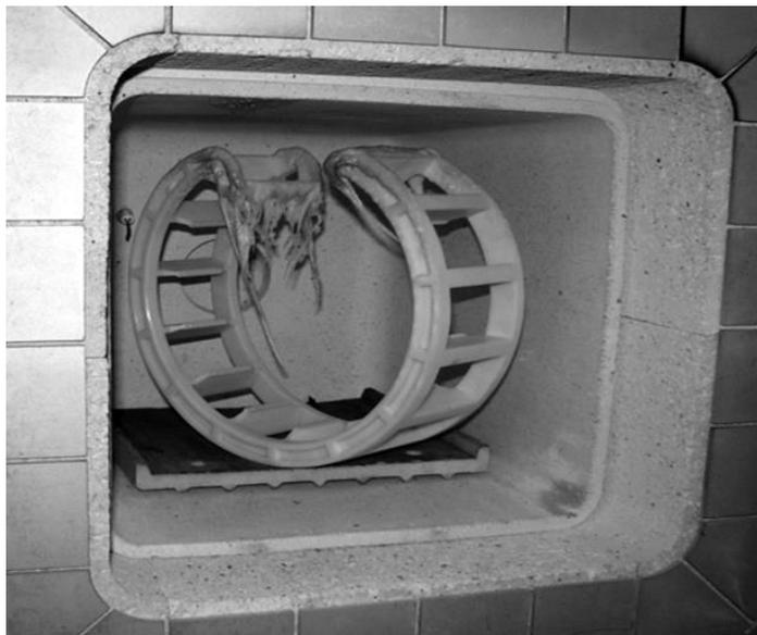
Рисунок 10 – Результат сушки стеклонаполненного полиамидного сепаратора в муфельной печи модели ПМ-14М1П-1250Т
