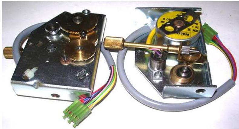
Рисунок 80 – Шаговый двигатель модели "КВА-Planeta"
