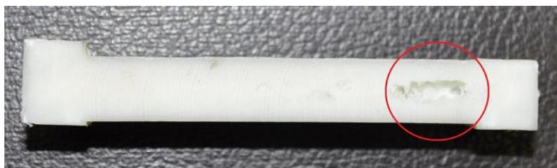
Рисунок 9 – Заводской брак в полиамидном сепараторе
