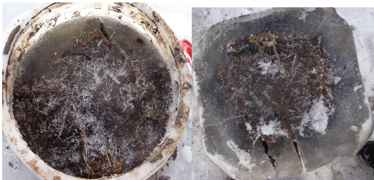
Рисунок Д.2 – Общий вид сверху вымороженного коллоидного осадка шлам-лигнина до и после его извлечения из бочек-канистр
