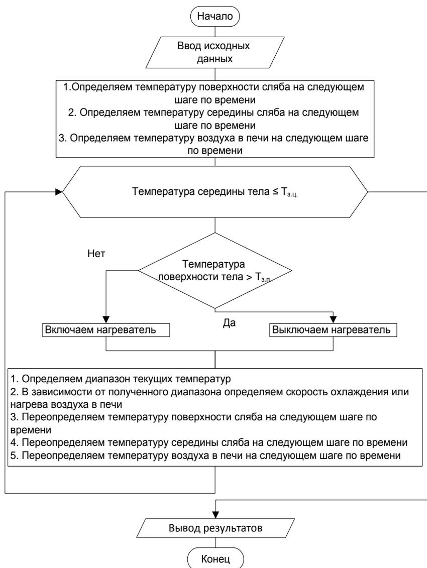
Рисунок 10 – Алгоритм управления нагревом материалов в печи
