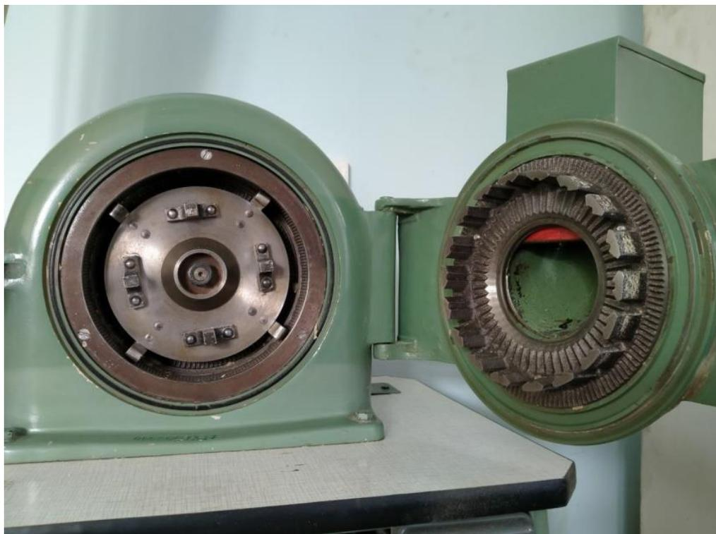
Рисунок 3.2 – Дезинтегратор-дробилка «Рекорд»
