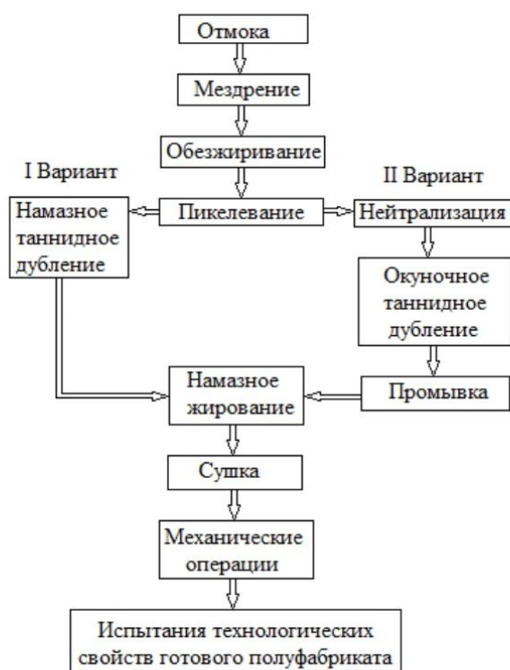
Рисунок 1 – Схема обработки мехового полуфабриката
