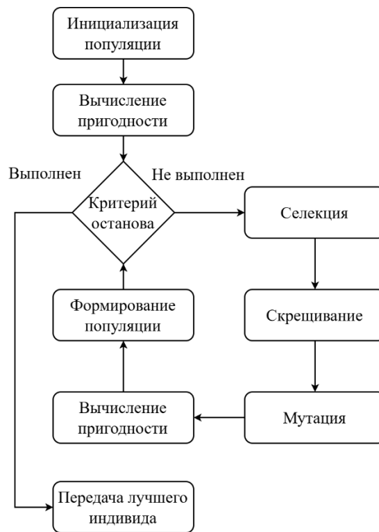
Рисунок 1.7 – Общая схема цикла работы генетического алгоритма
