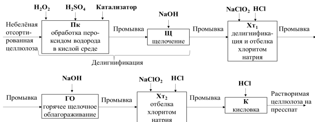
Рисунок 3.13 – Базовая схема отбели и облагораживания «жёсткой» бисульфитной целлюлозы
