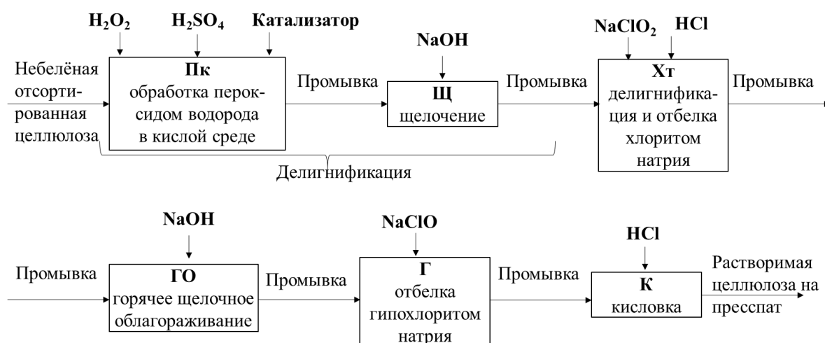
Рисунок 3.8 – Схема отбелки и облагораживания сульфитной еловой целлюлозы с получением вязкой целлюлозы
