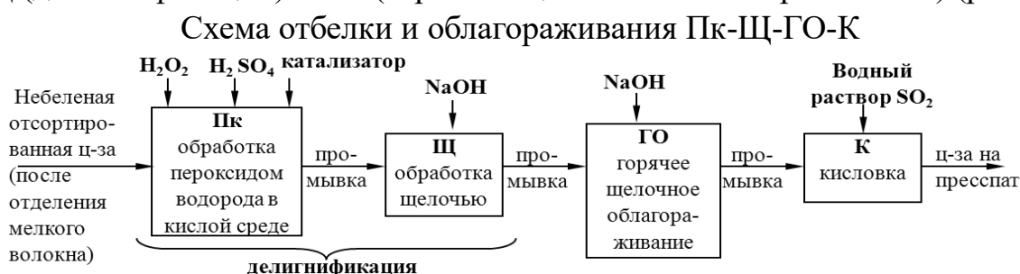
Рисунок 3.3 – Схема отбелки (ступеней делигнификации и горячего облагораживания) сульфитной еловой целлюлозы для химической переработки
