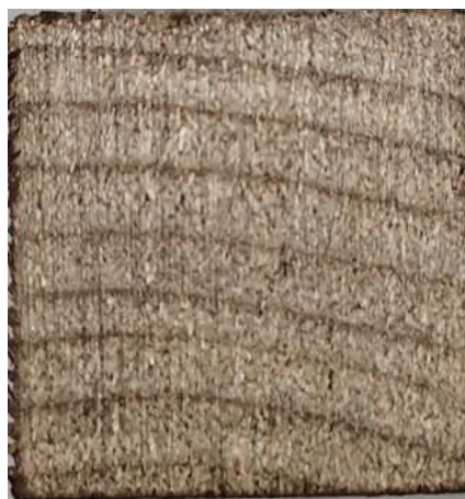
Рисунок 4.11 –Поперечный срез образца окрашенной древесины березы [136]
