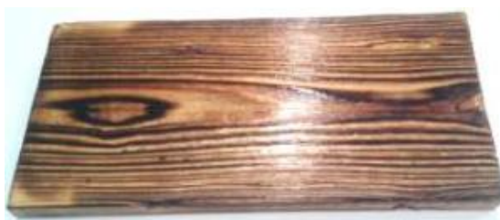
Рисунок 1.1 – Фактурная поверхность древесины с ярко выраженной текстурой после обжига и браширования [12]
