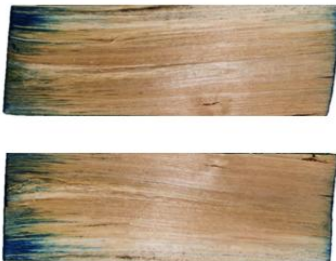
Рисунок 4.7 – Пропитанный текстильным красителем в автоклаве образец древесины березы с побурением (режим: P=0,6 МПа; \tau=30 мин; поглощение раствора 16%)
