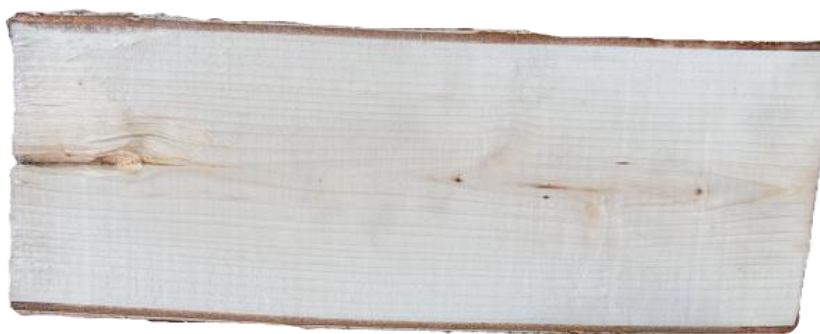
Рисунок 4.2 – Побурение древесины березы после выдержки в термостате в течении 5 суток [147]
