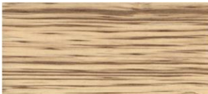
Рисунок 1.4 – Древесина пихты, перфорированная лазером и окрашенная[1]
