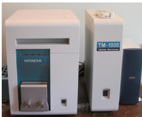
Рисунок 3.13 – Электронный микроскоп TM-1000 с энерго-дисперсионной приставкой EDS-SWIFT
