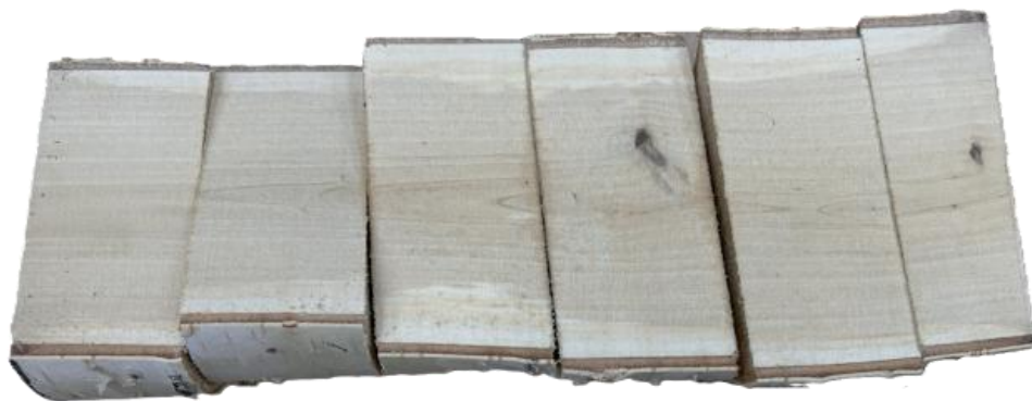
Рисунок 4.4 – Побурение древесины березы после выдержки в термостате в течении 15 суток [147]
