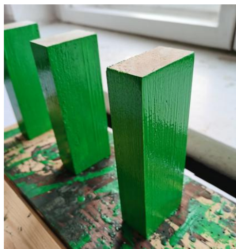
Рисунок 3.6 – Образцы с поверхностной изоляцией боковой поверхности
