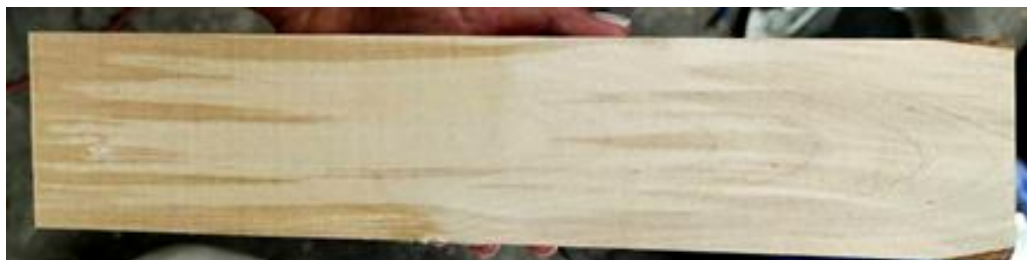
Рисунок 4.1 – Побурение образца древесины березы выдержанного в комнатных условиях
