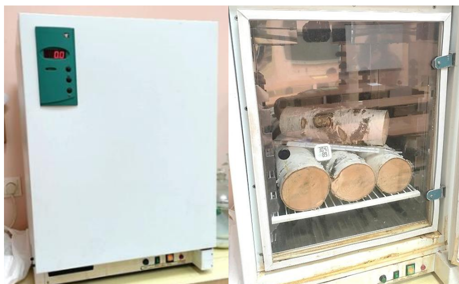
Рисунок 3.2 – Выдержка образцов в суховоздушном термостате СТ 1/80 СПУ
