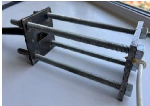
Рисунок 3.5 – Струбцина для фиксации образцов
