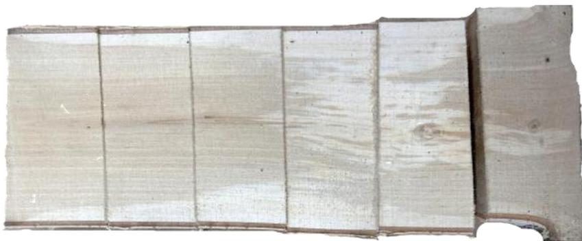
Рисунок 4.3 – Побурение древесины березы после выдержки в термостате в течение 10 сут [147]
