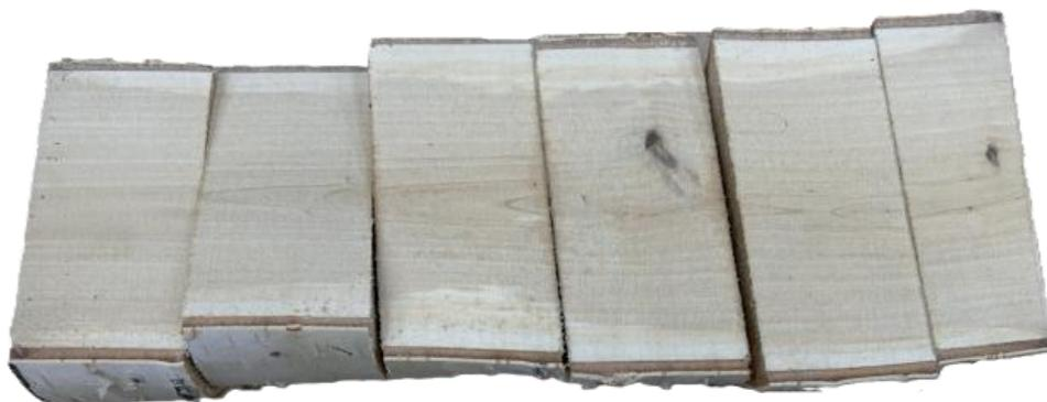
Рисунок 4.4 – Побурение древесины березы после выдержки в термостате в течение 15 сут [147]
