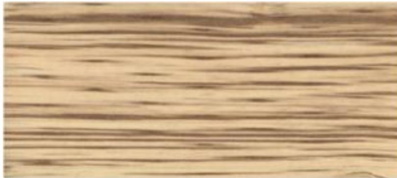
Рисунок 1.4 – Древесина пихты, перфорированная лазером и окрашенная [1]
