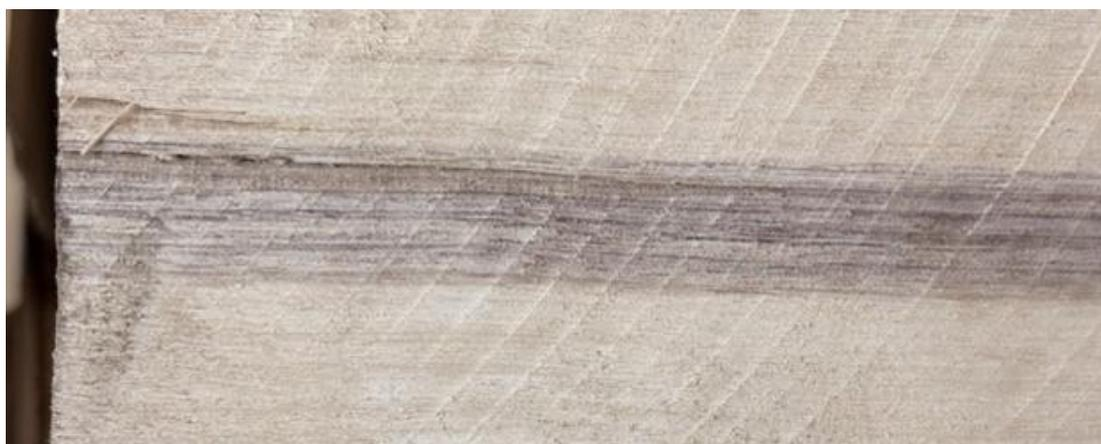
Рисунок 2.5 – Образец, пропитанный красителем, после локальной продувки воздухом (вдоль волокон) [68]
