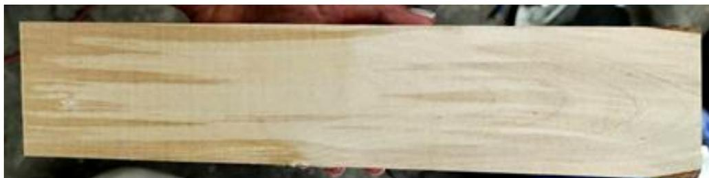
Рисунок 4.1 – Побурение образца древесины березы, выдержанного в комнатных условиях
