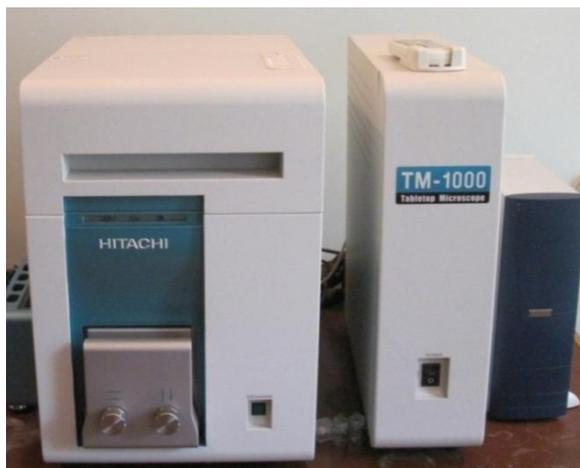
Рисунок 3.13 – Электронный микроскоп TM-1000 с энерго-дисперсионной приставкой EDS-SWIFT
