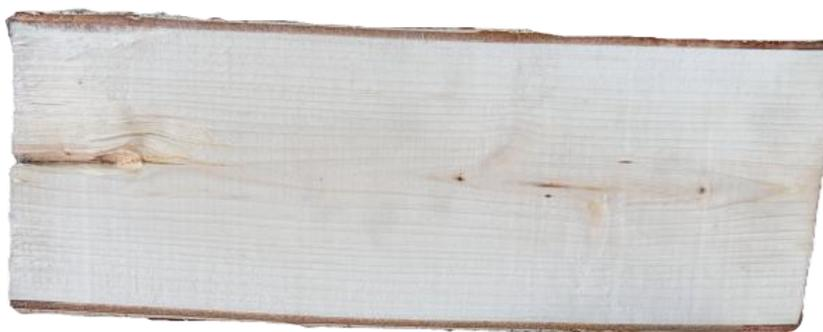
Рисунок 4.2 – Побурение древесины березы после выдержки в термостате в течение 5 сут [147]
