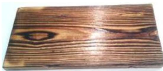
Рисунок 1.1 – Фактурная поверхность древесины с ярко выраженной текстурой после обжига и браширования [12]
