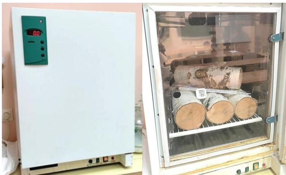
Рисунок 3.2 – Выдержка образцов в суховоздушном термостате СТ 1/80 СПУ
