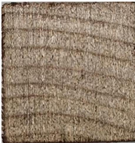
Рисунок 4.11 – Поперечный срез образца окрашенной древесины березы [136]
