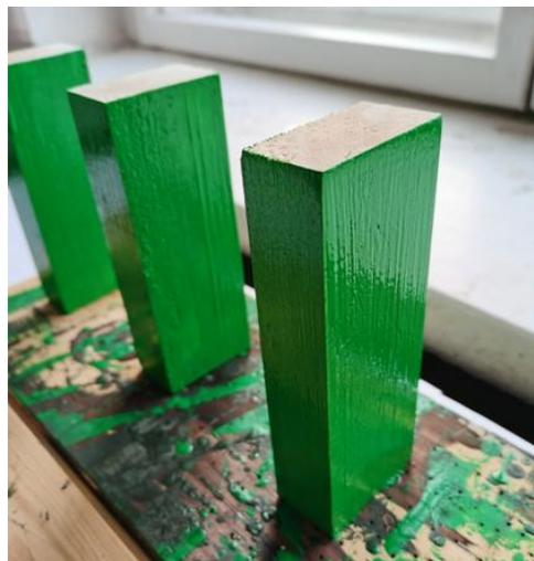
Рисунок 3.6 – Образцы с поверхностной изоляцией боковой поверхности
