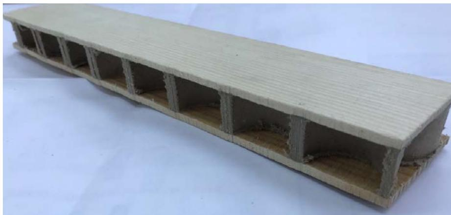
Рис. 1. Облегченный материал с наружными слоями из шпона
