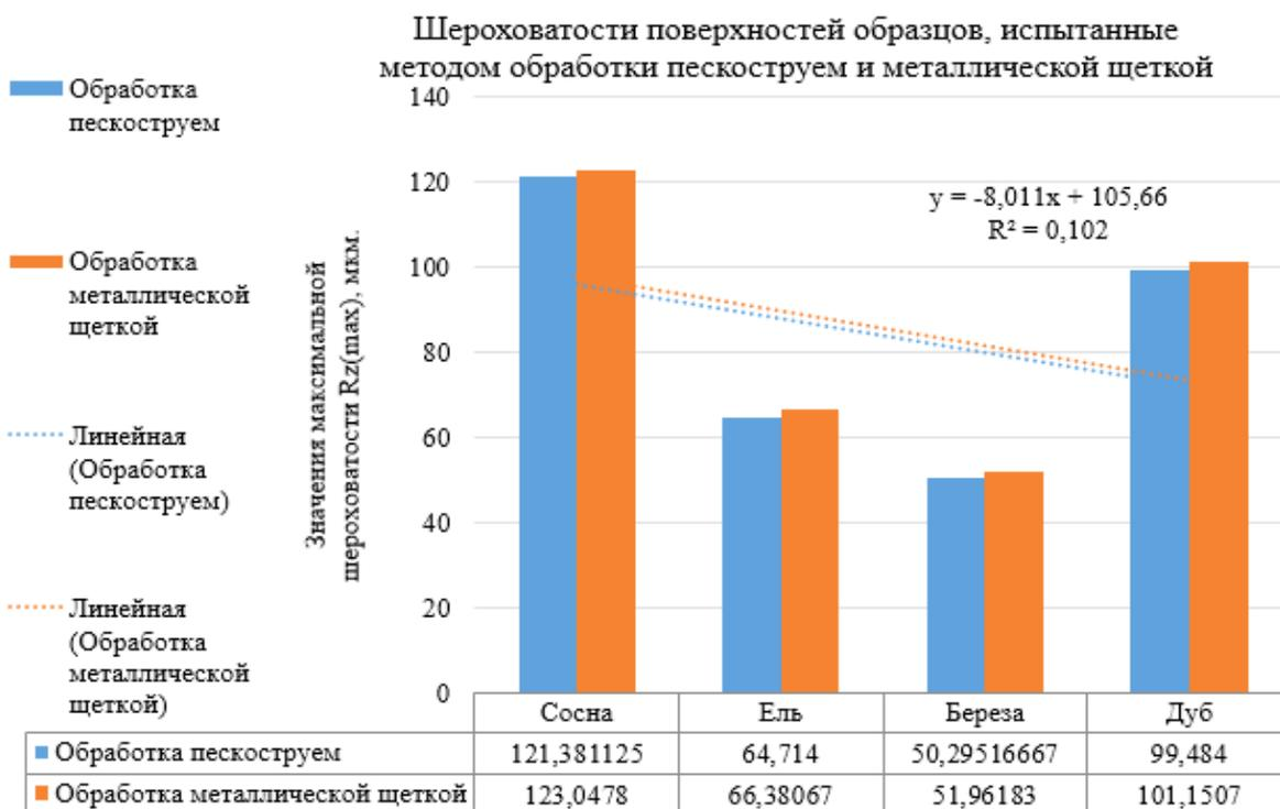
Шероховатость поверхности древесины, полученная пескоструйной обработкой и шлифованием металлической щеткой
