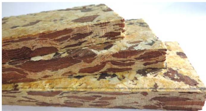
Рис. 1. Образцы плит из коры и стружки
