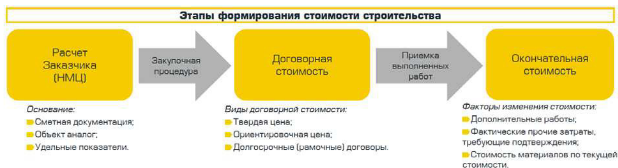
Рис. 2. Этапы формирования стоимости строительства, разработаны автором
