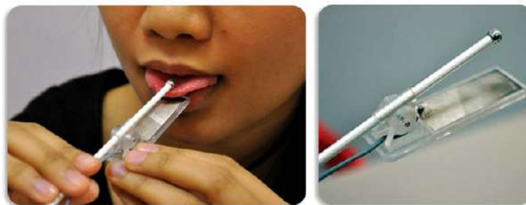
Рис. 1. Электрод, способный имитировать вкусовые ощущения
