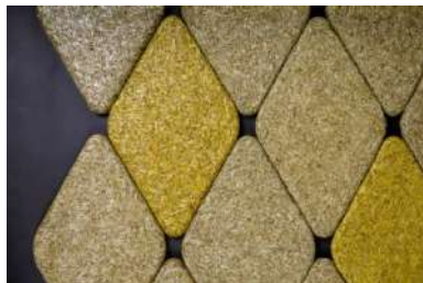
Рис. 1. Шумоподавляющие панели из хвойных иголок
