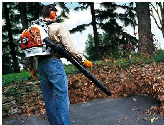
Рисунок 1 – Применение ранцевого воздуходува STIHL BR 200 при очистке дорожек
