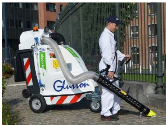
Рисунок 5 – Компактная вакуумно-уборочная машина Glutton
