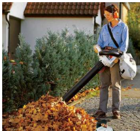
Рисунок 2 – Работа ручного газоочистителя STIHL SH 86D в режиме всасывания
