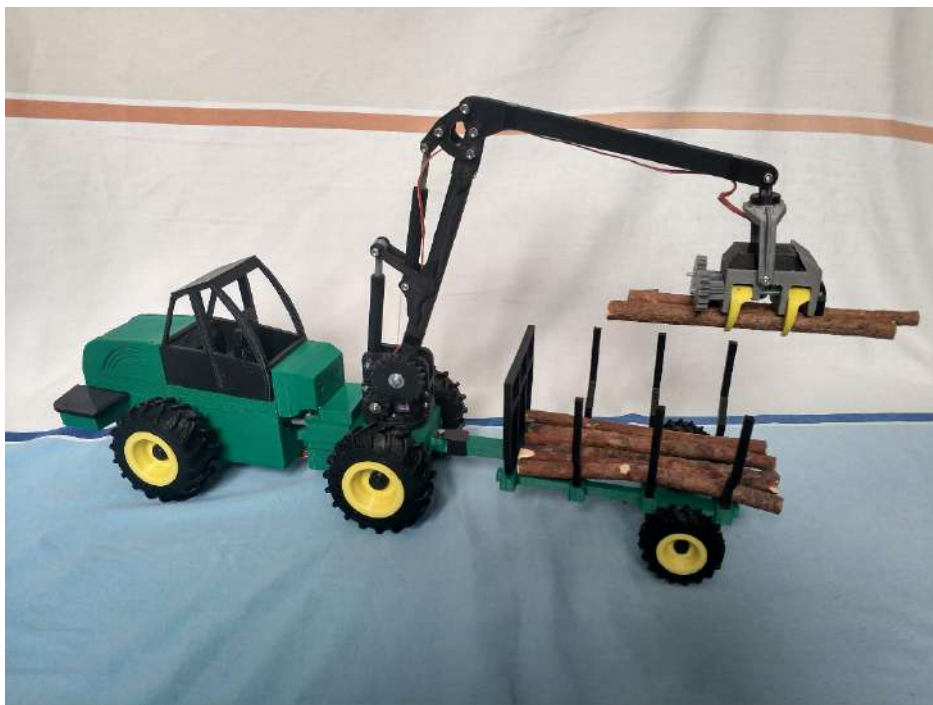
Рисунок 9 – физическая роботизированная модель универсальной лесозаготовительной машины
