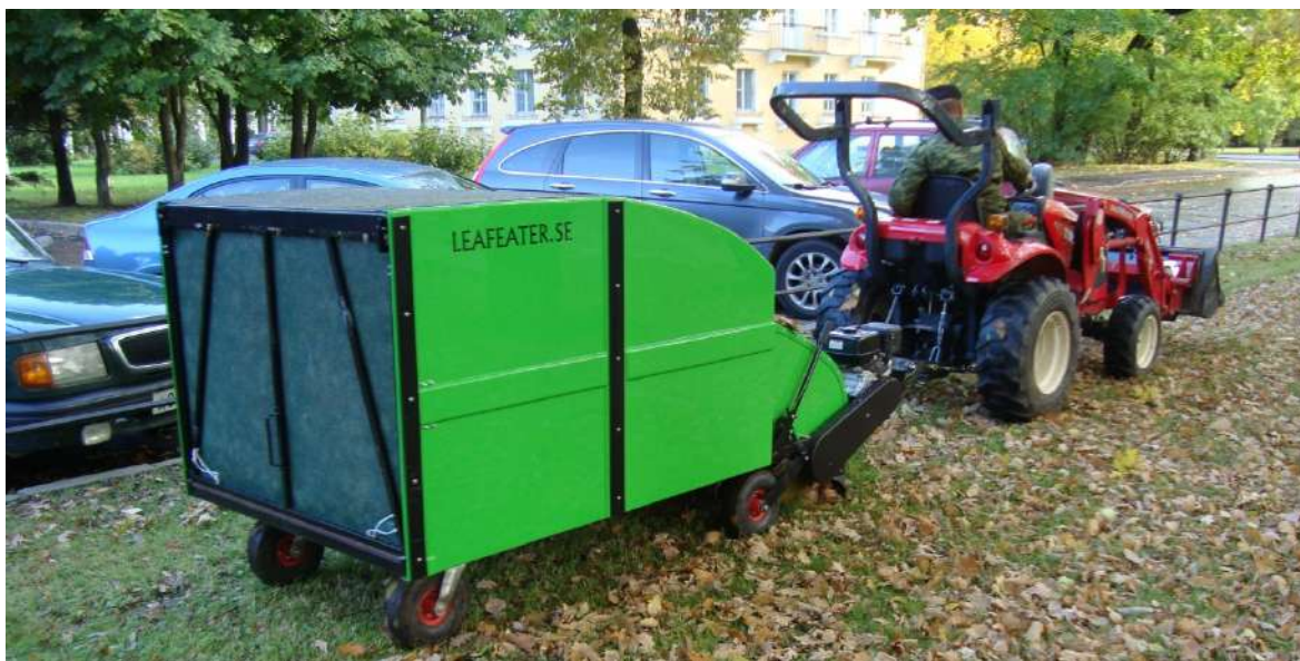
Рисунок 1 – Общий вид листоуборочной машины (механического газоочистителя) Leaf eater 1100 (Швеция)
