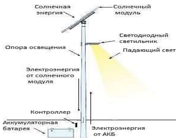
Рисунок 3 – Составляющие автономного освещения
