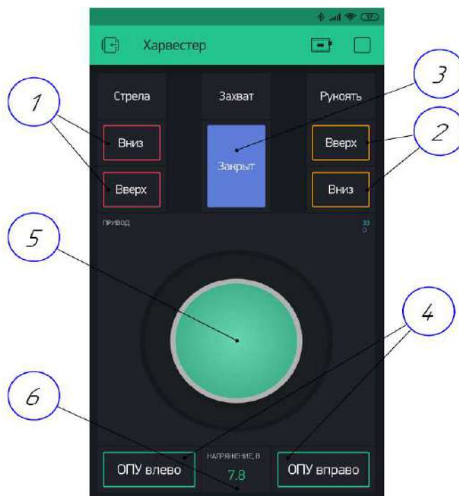
Рисунок 2 – Интерфейс управления моделью в приложении «BLYNK»: 1 – кнопки поднятия/опускания стрелы, 2 – кнопки поднятия/опускания рукояти, 3 – кнопка открытия/закрытия захвата, 4 – кнопки поворота манипулятора, 5 – двухосевой джойстик управления перемещением и поворотом машины, 6 – индикатор заряда
