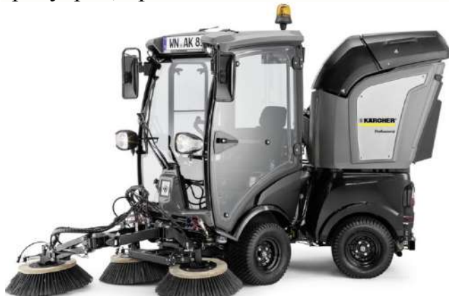
Рисунок 4 – Субкомпактная вакуумно-подметальная машина Karcher MC 50
