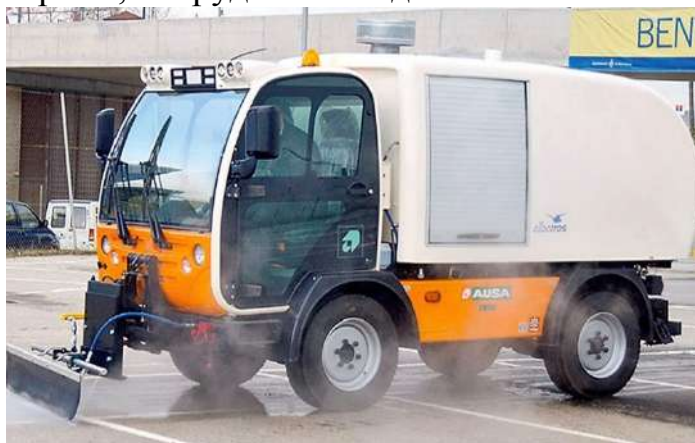
Рисунок 3 – Поливомоечная машина Ausa M350H
