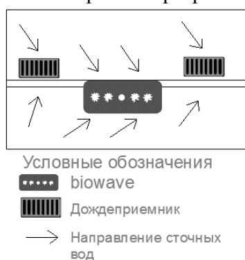
Рисунок 1 – Поперечный разрез «Bioswave»
