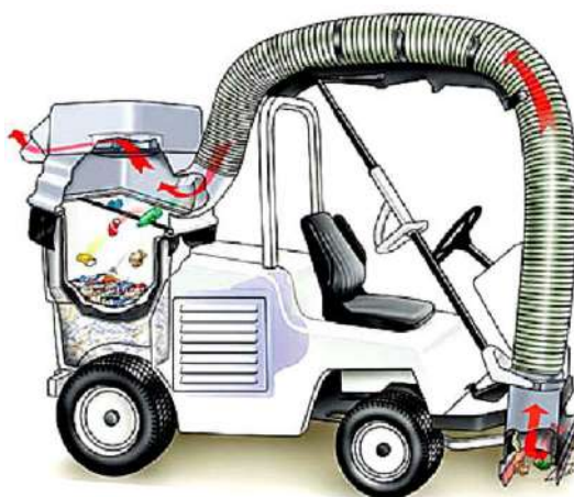
Рисунок 3 – Принцип действия вакуумно-уборочной машины
