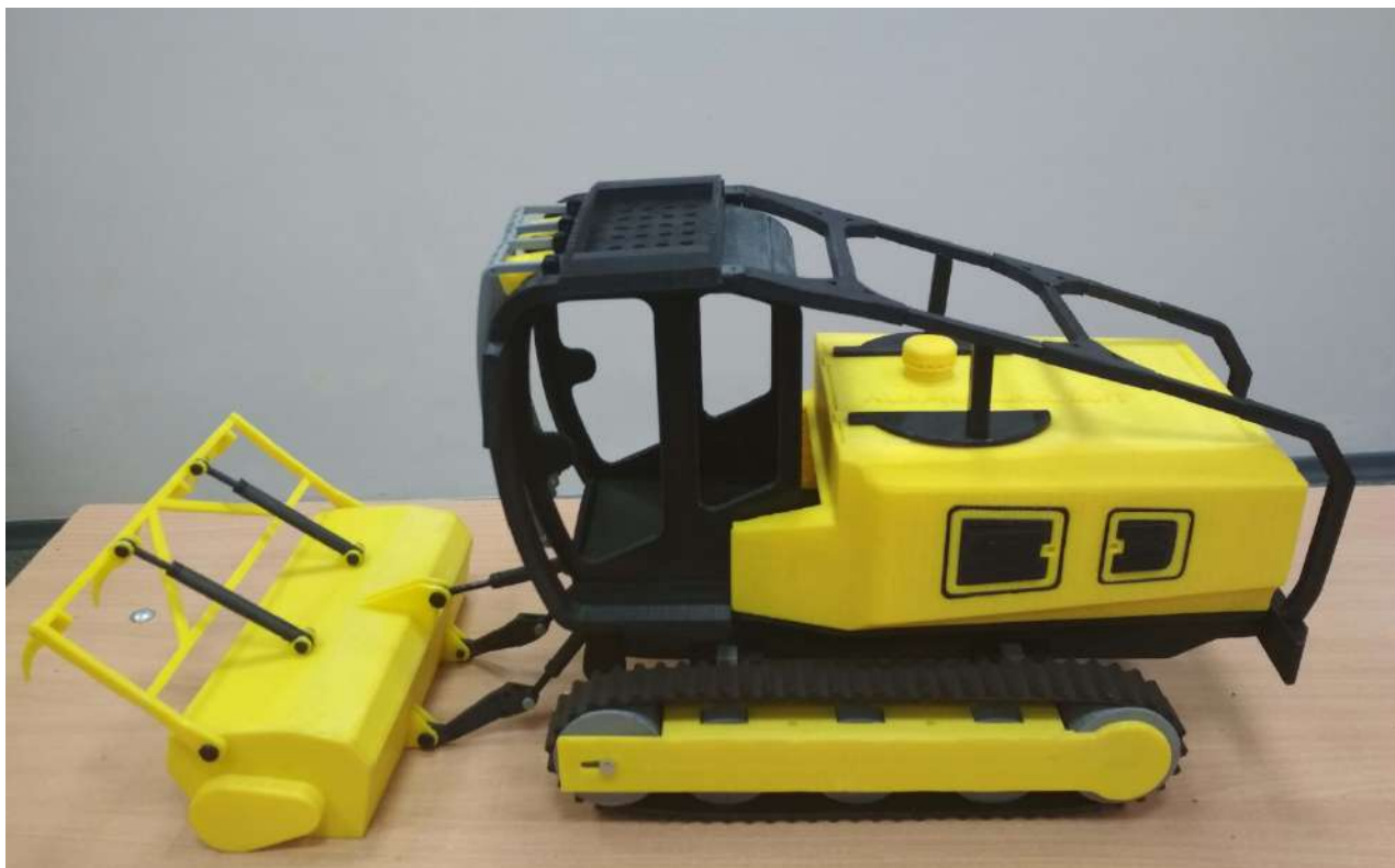
Рисунок 7 – Физическая модель мульчера ТМ-250
