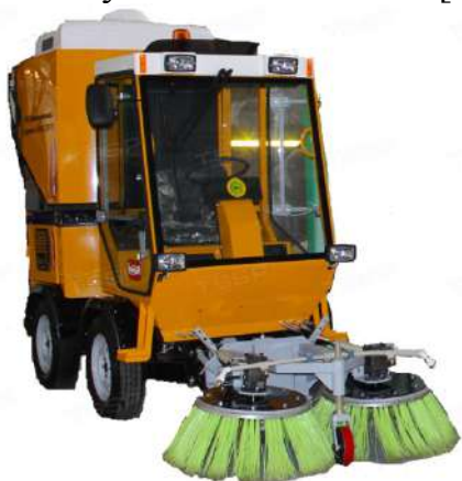
Рисунок 1 – Вакуумная подметально-уборочная машина BTM SweeperR 4x4
