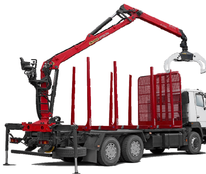
Рис. 3. Гидроманипулятор ВЕЛМАШ С70L77
