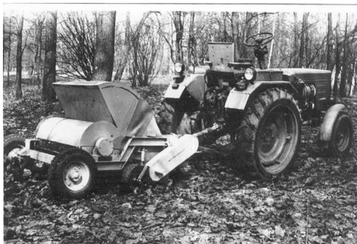
Рисунок 2 – Машина для сбора и измельчения опавших листьев
