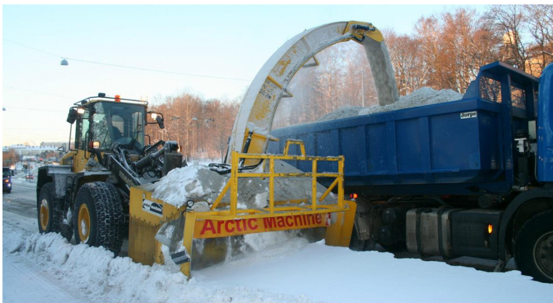
Рисунок 3 – Работа роторной снегоуборочной машины с погрузкой снега в транспортное средство
