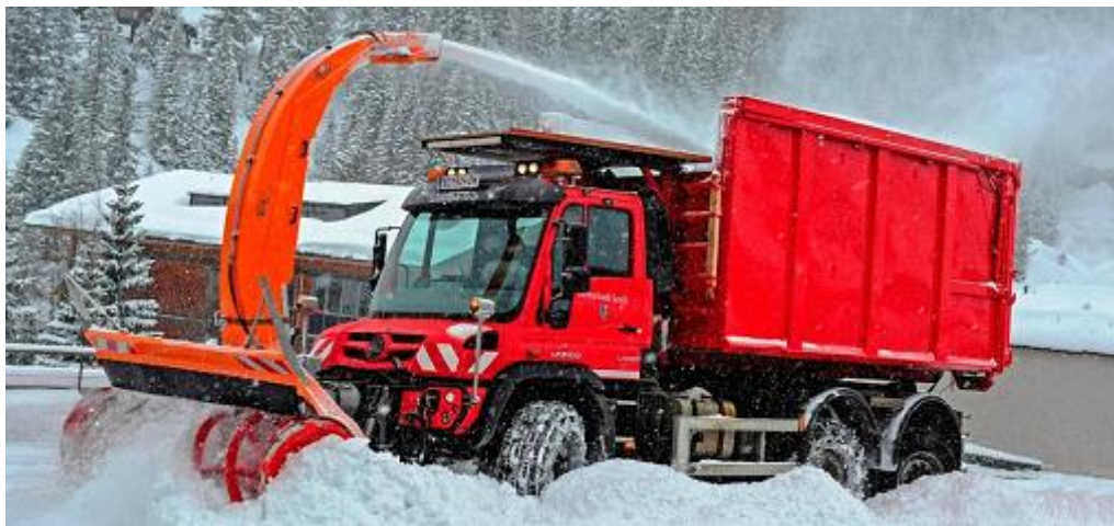
Рисунок 4 – Специальная универсальная снегоуборочная машина на базе шасси Mercedes-Benz Unimog U 530
