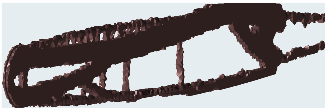
Рисунок 2 - результат программной оптимизации в Altair Inspire 2018.3
