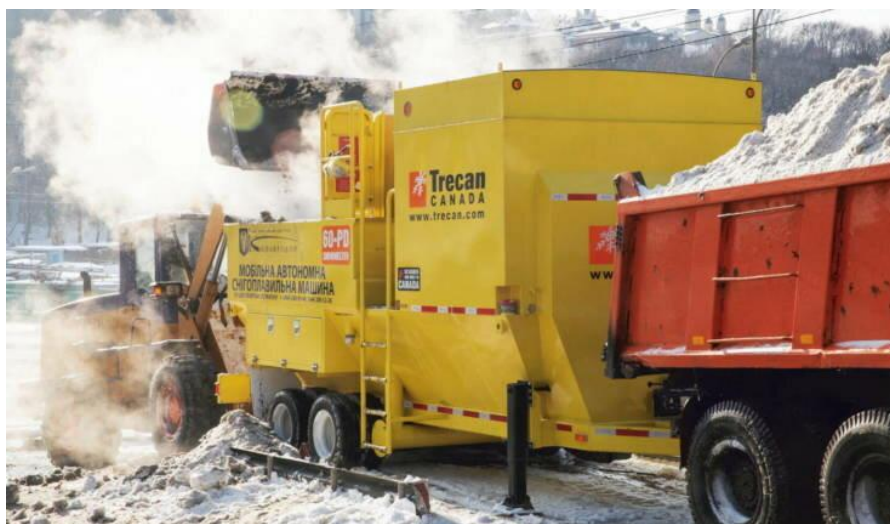
Рисунок 3 – Снегоплавильная установка в Канаде
