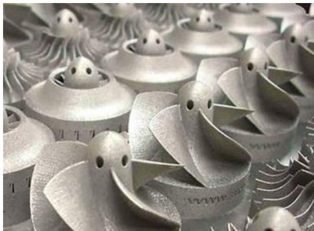
Рисунок 1 – Пример детали сложной конфигурации изготовленные по технологии селективного лазерного плавления
