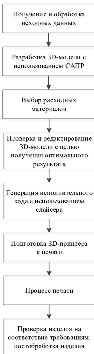
Рисунок 1 – Алгоритм производства изделий методом послойного наплавления
