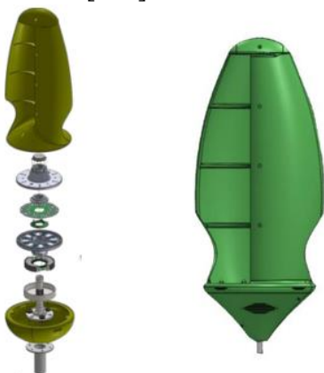
Рисунок 2 – Составная конструкция «Ветряного листа»
