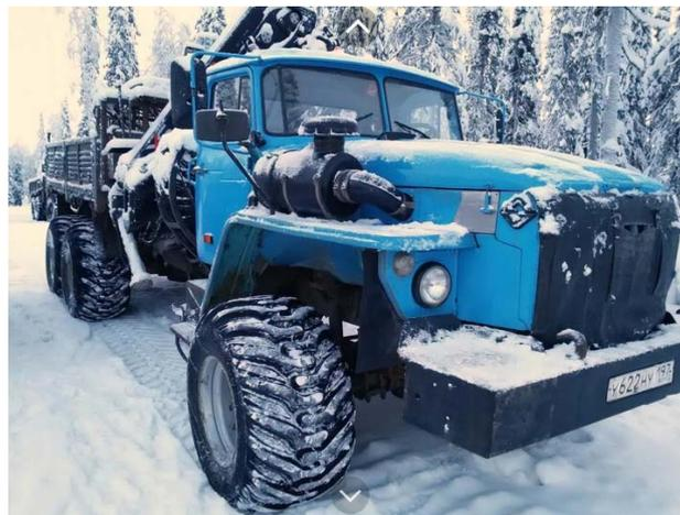
Рис. 3. Урал 4320 на широкопрофильных шинах 1150×620×22,5 Бел 91
