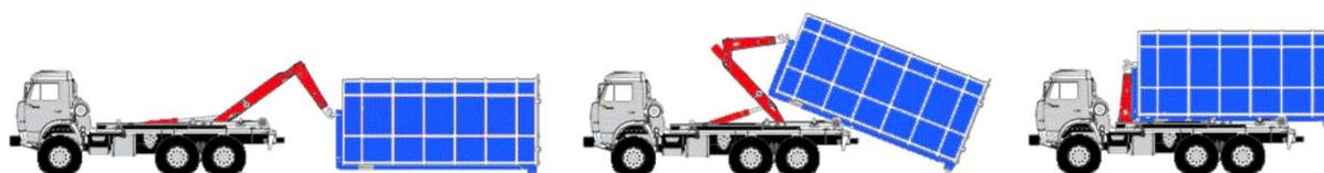
Рис. 1. Схема работы системы мультилифт
