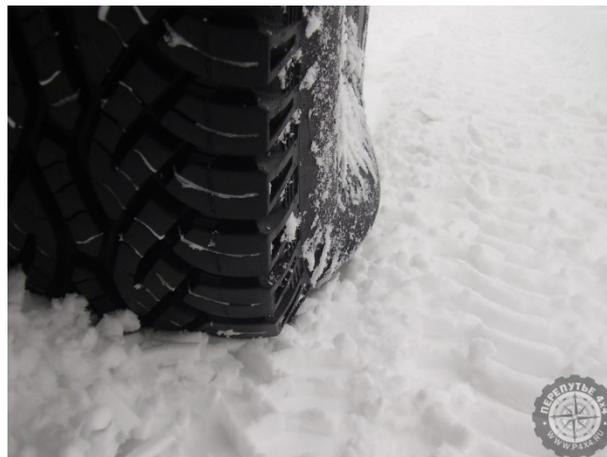
Рис. 1. Пониженное давление в шинах
