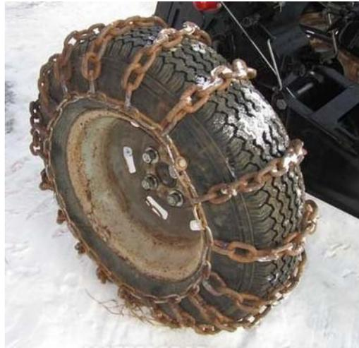
Рис. 2. Колесо с использованием цепей-грунтозацепов
