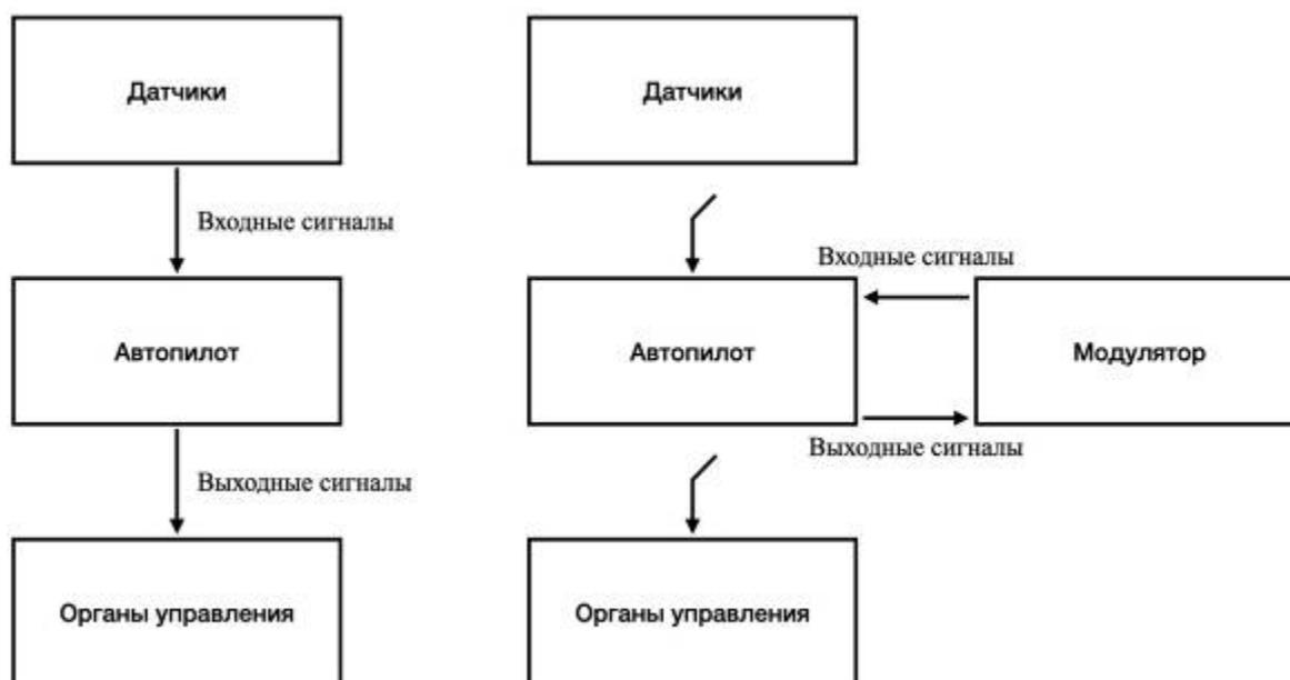
Рис. 2. Блок-схема работы автопилота при подключении модулятора
