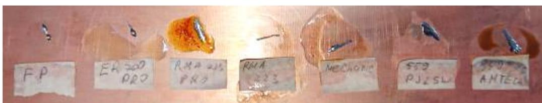
Рис. 2. Тест на смачиваемость медной пластины припоем
