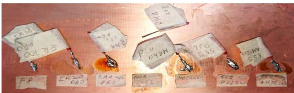
Рис. 3. Результаты пайки медного провода к медной пластине
