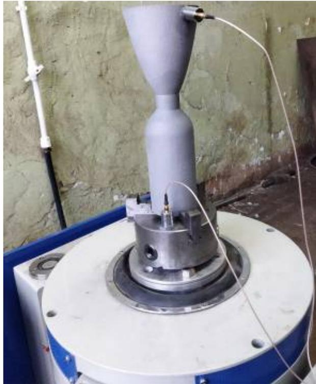
Рис. 2. Вертикальное положение камеры на стенде
