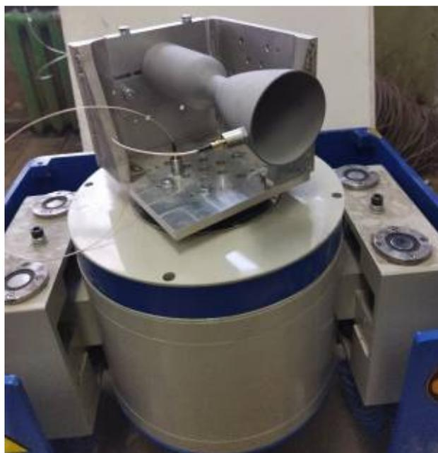
Рис. 3. Горизонтальное положение камеры на стенде
