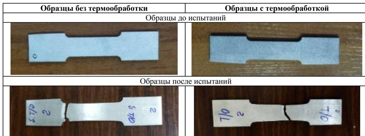
Рис. 3. Фотографии образцов для испытаний на растяжение
