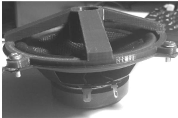
Рис. 2. Доработанная широкополосная акустическая система типа FM1130
