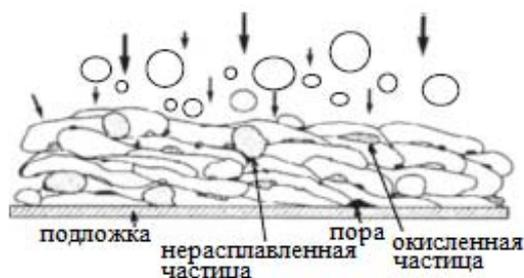
Рис. 1. Схема формирования покрытий при напылении
