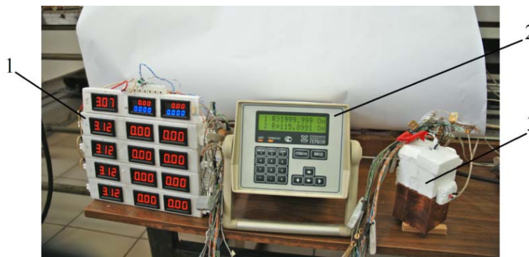
Рис. 1. Общий вид стенда для градуировки термисторов по образцовому термометру сопротивления:
