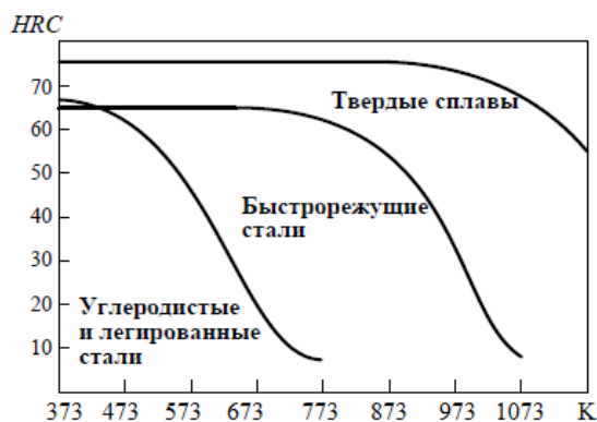
Рис. 1. Зависимость твердости различных инструментальных материалов от температуры нагрева
