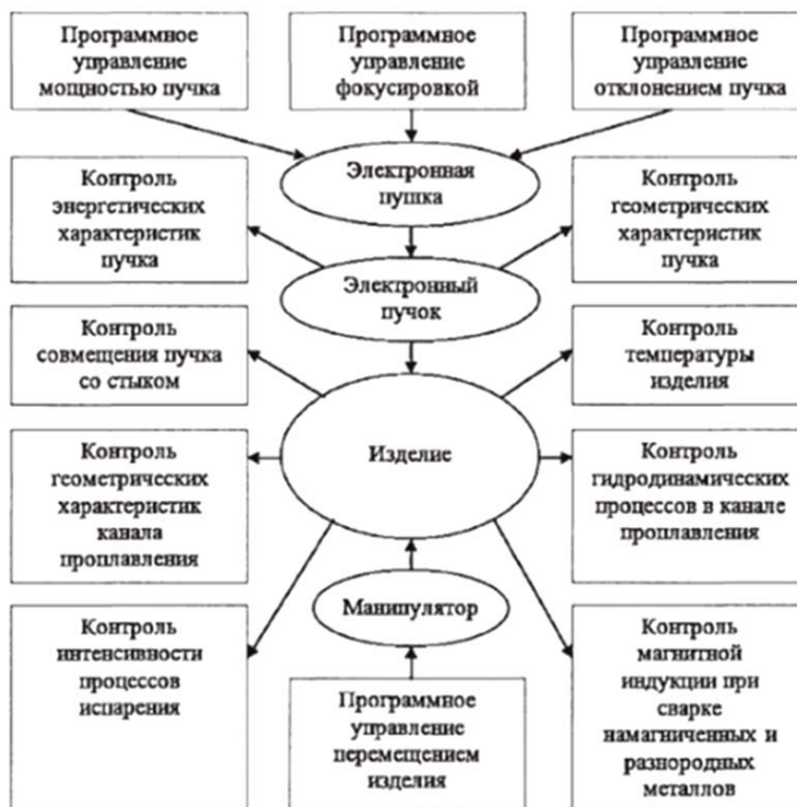
Рис. 1. Пути автоматизации процессов электронно-лучевой сварки и обработки
