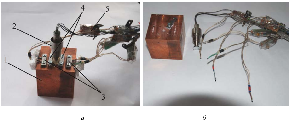
Рис. 3. Общий вид сборки без теплоизолирующего покрытия (а): 1 – термостатирующий медный куб (ребро 60 мм); 2 – образцовый платиновый термометр сопротивления ТП 198; 3 – прижимные планки с термисторами; 4 – внутренние прижимные планки с термометром сопротивления; 5 – функциональная плата термисторов. Вид сборки в составе элементов (б)
