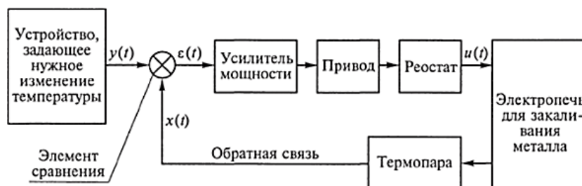
Рис. 2. Функциональная схема автоматической системы, реализующей процесс закаливания металла в электропечи
