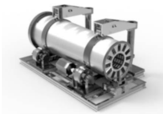
Рис. 4. Установка для центробежной сушки и пропитки пиломатериалов
