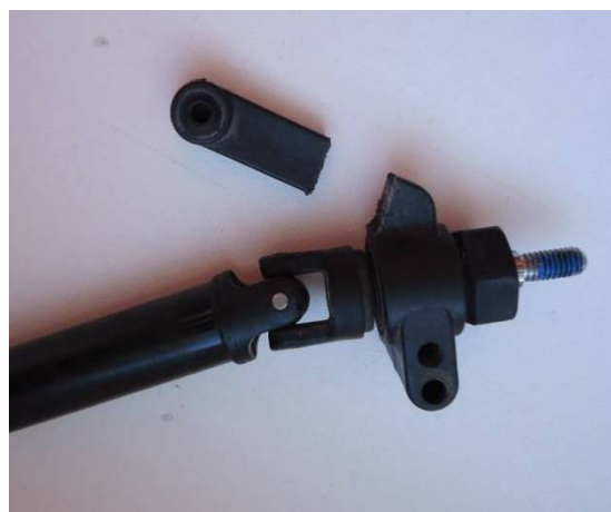
Рис. 1. Узел подвески с повреждением фрагмента ступицы заднего колеса в сборе
