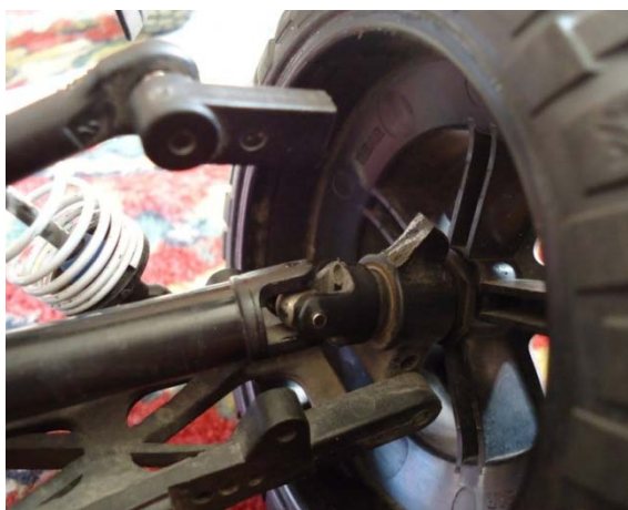
Рис. 1. Узел подвески с повреждением фрагмента ступицы заднего колеса в сборе
