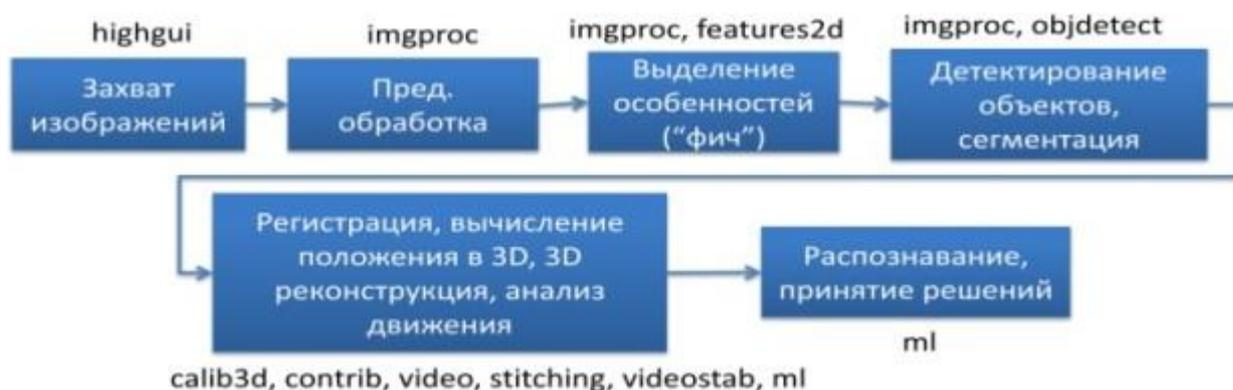
Рисунок 2 - Схема типичного приложения компьютерного зрения.
